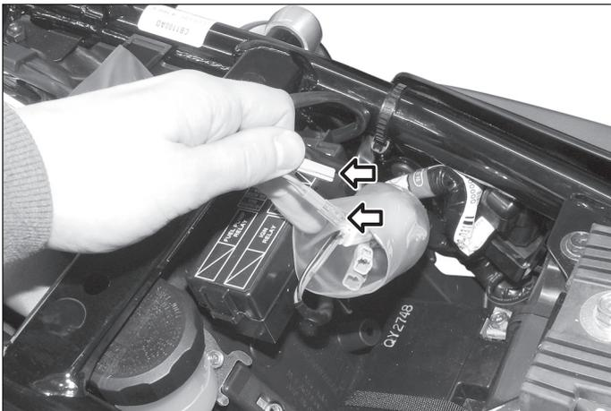
**2** Trennen Sie die Steckverbindungen der Blinkerkabel (Orange und Blau). Disconnect the plugs of the blinker cables (orange and blue).
