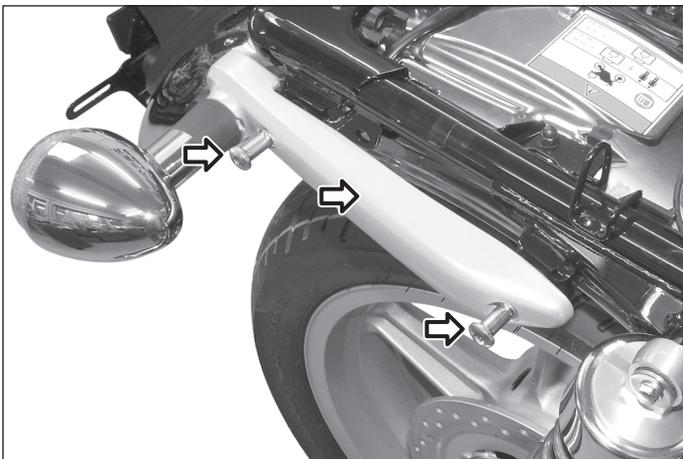
**3** Entfernen Sie beidseitig die Gepäckhaken und Seitenstreben vom Fahrzeug. Remove the luggage hooks and side struts (both sides of the vehicle).
