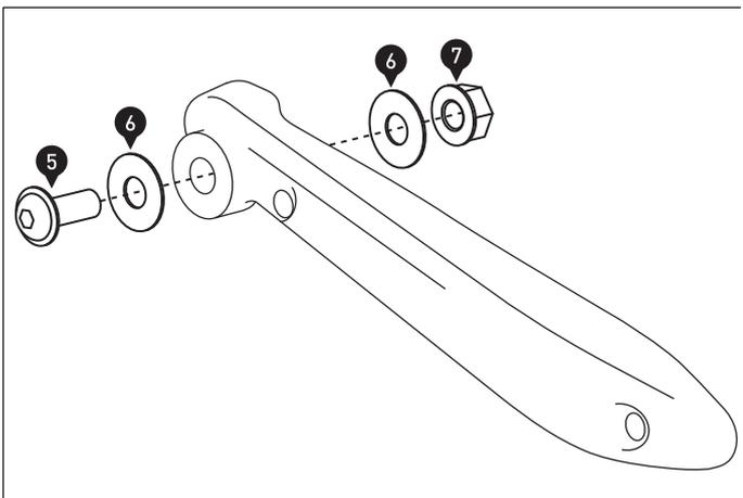
**12** Verschließen Sie die Blinkeröffnungen der Seitenstreben mit den gezeigten Teilen. Ziehen Sie die Schrauben wie in der Stückliste vorgegeben an.
