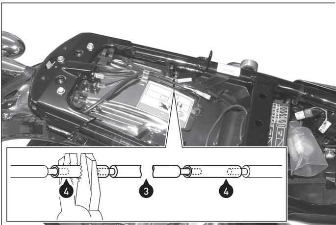
**11** Nun müssen die original Blinkerkabel verlängert werden. Durchtrennen Sie die original Kabel. Entfernen Sie die Isolierungen an den Kabelenden. Verwenden Sie die Kabelverbinder (4), um die Kabelenden mit den mitgelieferten Kabelverlängerungen (3) zu verbinden, wie in der Zeichnung gezeigt. Verbinden Sie anschließend die Blinkerstecker mit dem Bordnetz.
