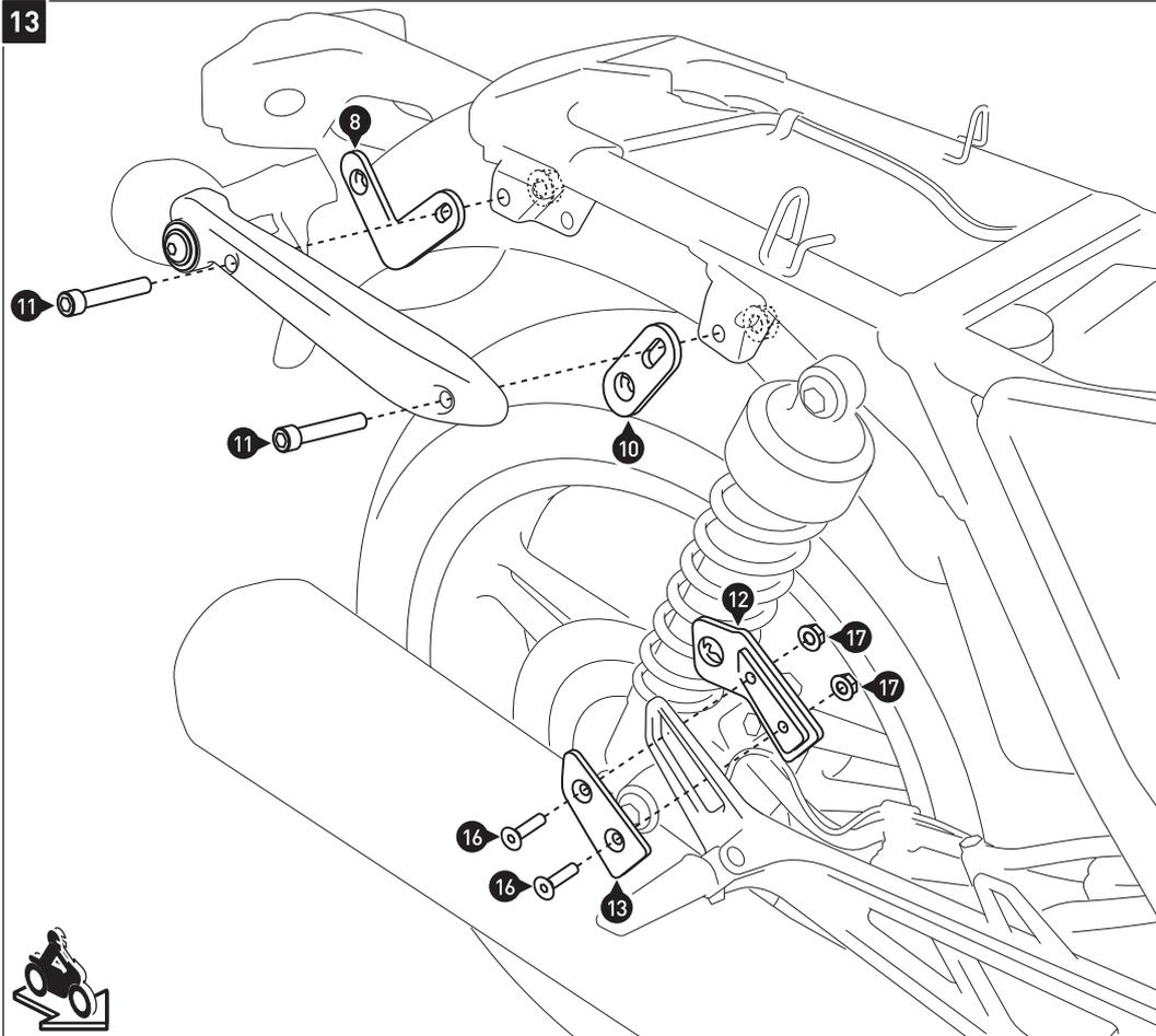
Verschrauben Sie die Seitenstreben mit den Schrauben (11), den Befestigungslaschen (8), (9) und (10) sowie den original Muttern am Fahrzeug.
