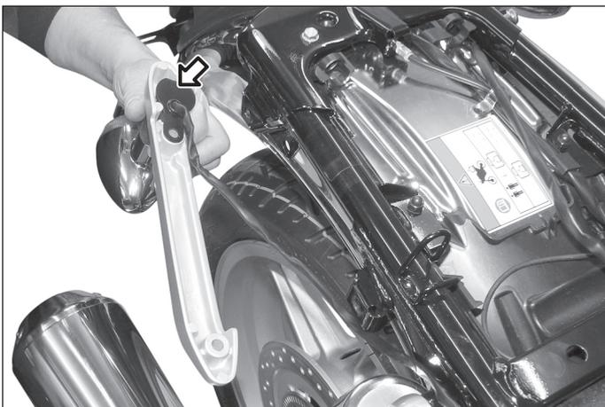
**4** Entfernen Sie beidseitig die Abdeckbleche. Remove the cover sheets (both sides of the vehicle).
