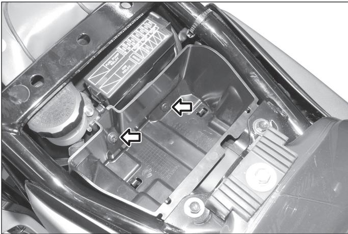
**1** Entfernen Sie die Sitzbank. Lösen Sie die markierten Verbindungen und entfernen Sie das Ablagefach. Remove the Seat. Loosen the marked connections, then remove the storage box.
