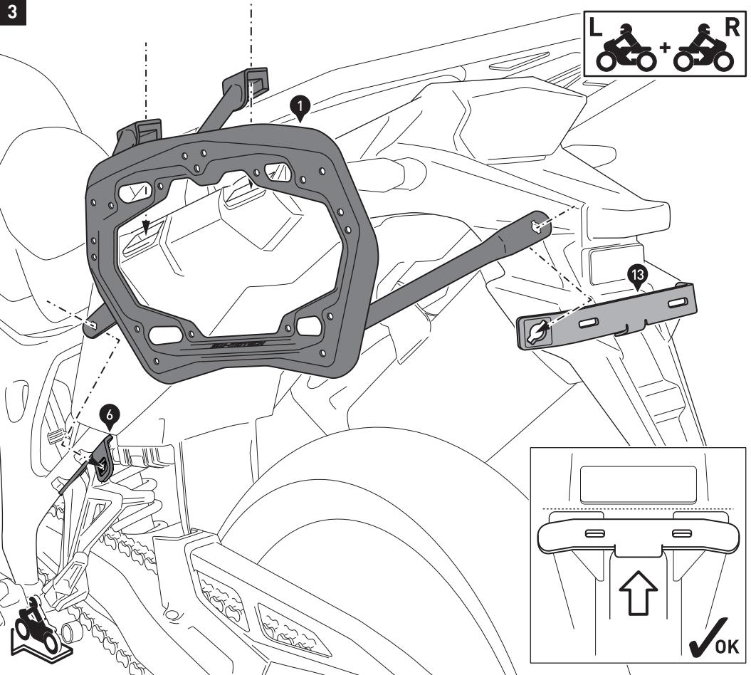
Hängen Sie die Seitenträger (1) beidseitig in die Heckmulden des Fahrzeugs und verbinden Sie diese mit den Schnellverschlüssen (18) am Querverbinder (13) und den Befestigungslaschen (6) und (9/10).
