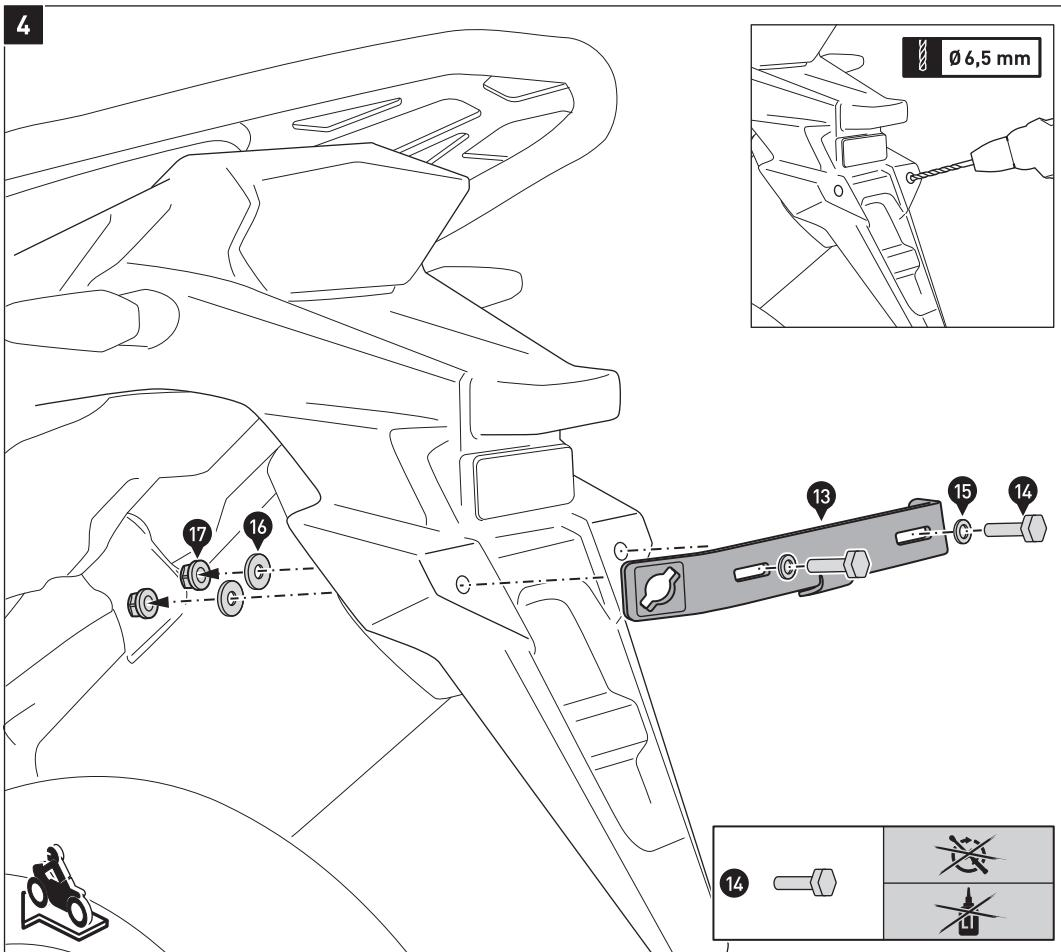
Bohren Sie zwei Löcher mit einem Durchmesser von 6,5 mm in den Kotflügel, wie in der Detailzeichnung gezeigt.
