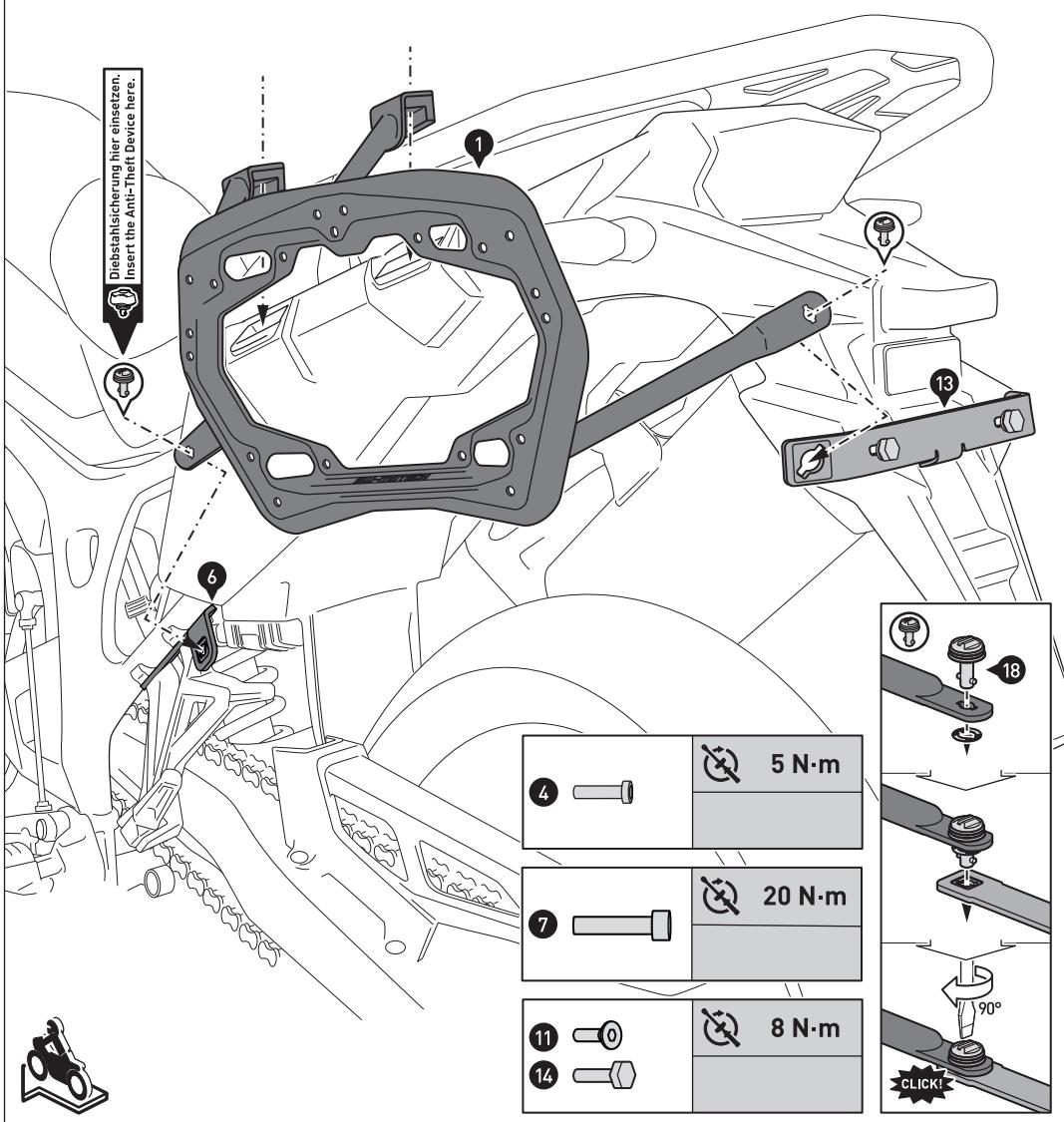
Verbinden Sie die Seitenträger (1) mit den Schnellverschlüssen (18) am Querverbinder (13) und den Befestigungslaschen (6) und (9/10). Sichern Sie die Schnellverschlüsse mit den Sicherungsscheiben.
