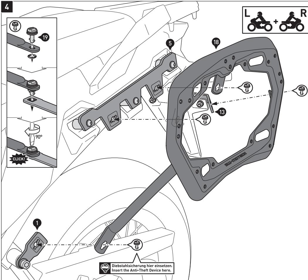
Verbinden Sie die Seitenträger (18) mit den Schnellverschlüssen (19) an den Befestigungslaschen (1) und (5) und dem Querverbinnder (13).
