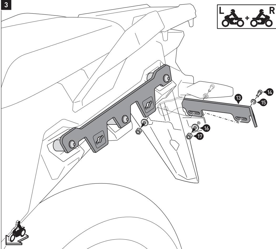
Verschrauben Sie den Querverbinnder (13) an der Kennzeichenhalterung, wie in der Zeichnung gezeigt.
