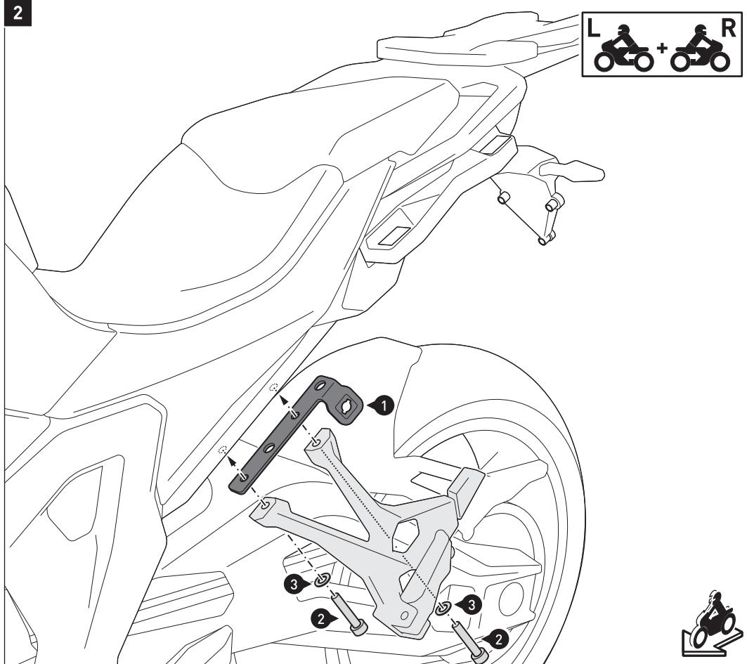
Verschrauben Sie die Befestigungslaschen [1] **beidseitig** mit den Soziusfußrastenhaltern am Fahrzeug.
