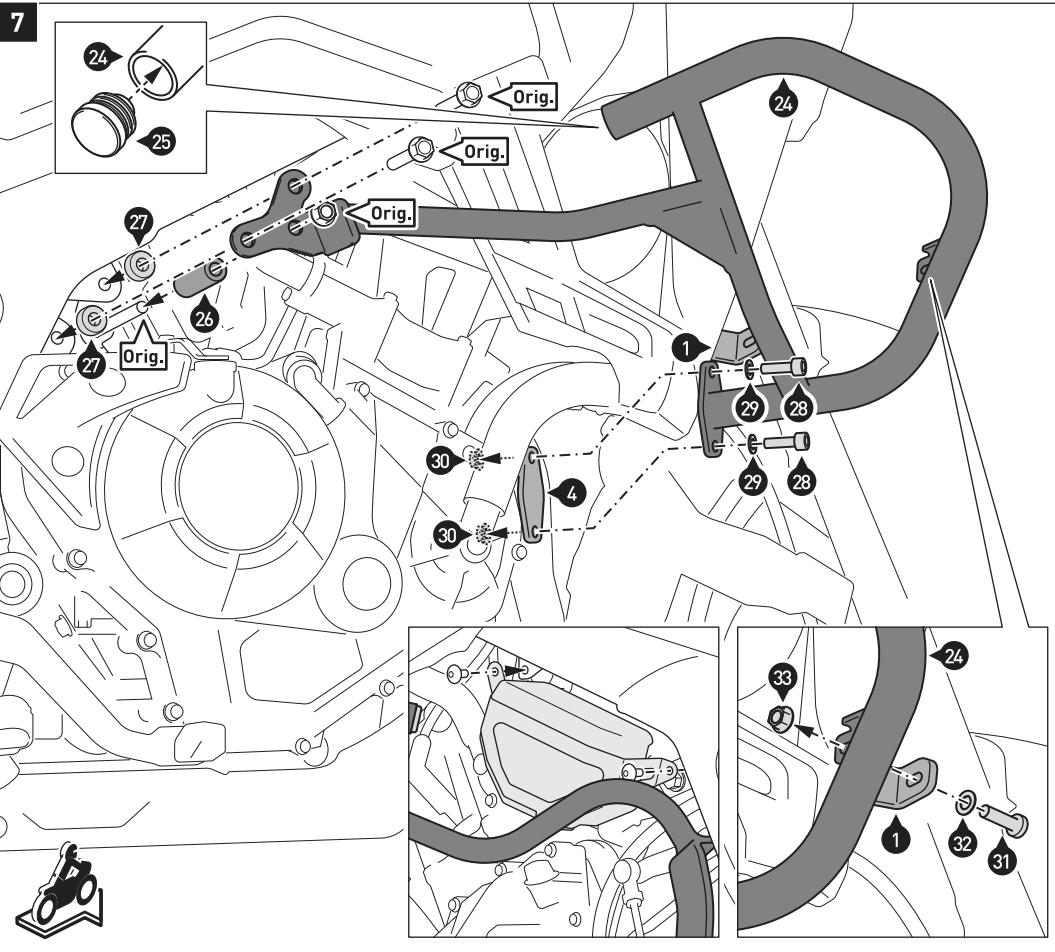
Setzen Sie den Kunststoffstopfen (25) in den Sturzbügel (24) ein.
