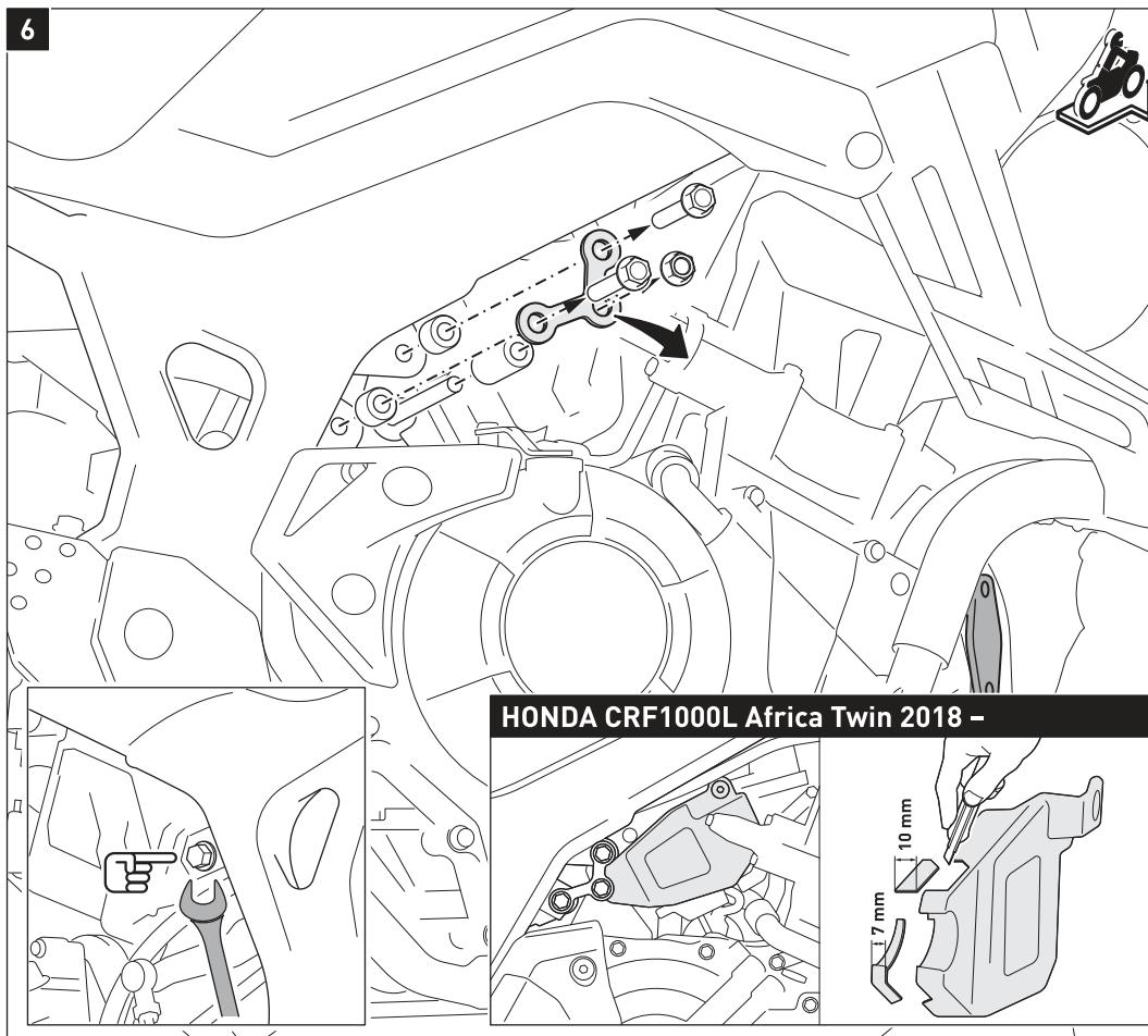
Entfernen Sie die gezeigten original Schrauben, Mutter, Anbaublech und Distanzbuchsen von der rechten Fahrzeugseite. Um die Mutter zu lösen, muss der in der linken Detailzeichnung gezeigte Schraubenkopf (linke Fahrzeugseite, hinter der Werkzeugbox) gehalten werden.
