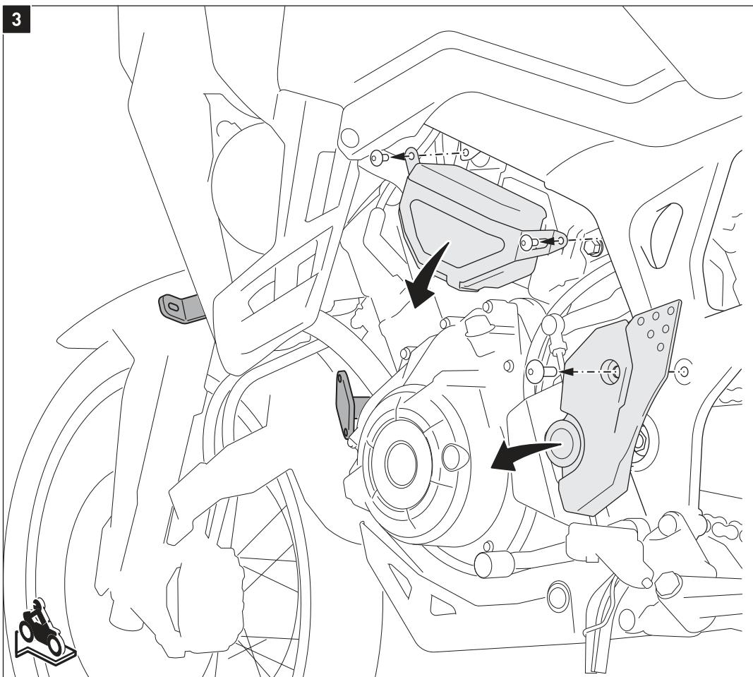
Lösen Sie die gezeigten original Schrauben und entfernen Sie die Werkzeugbox und den Fersenschutz von der linken Fahrzeugseite.
