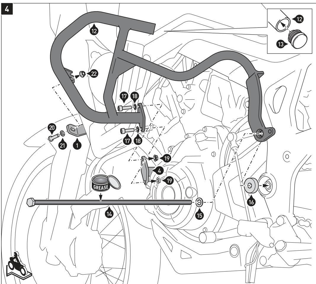
Setzen Sie den Kunststoffstopfen (13) in den Sturzbügel (12) ein.
