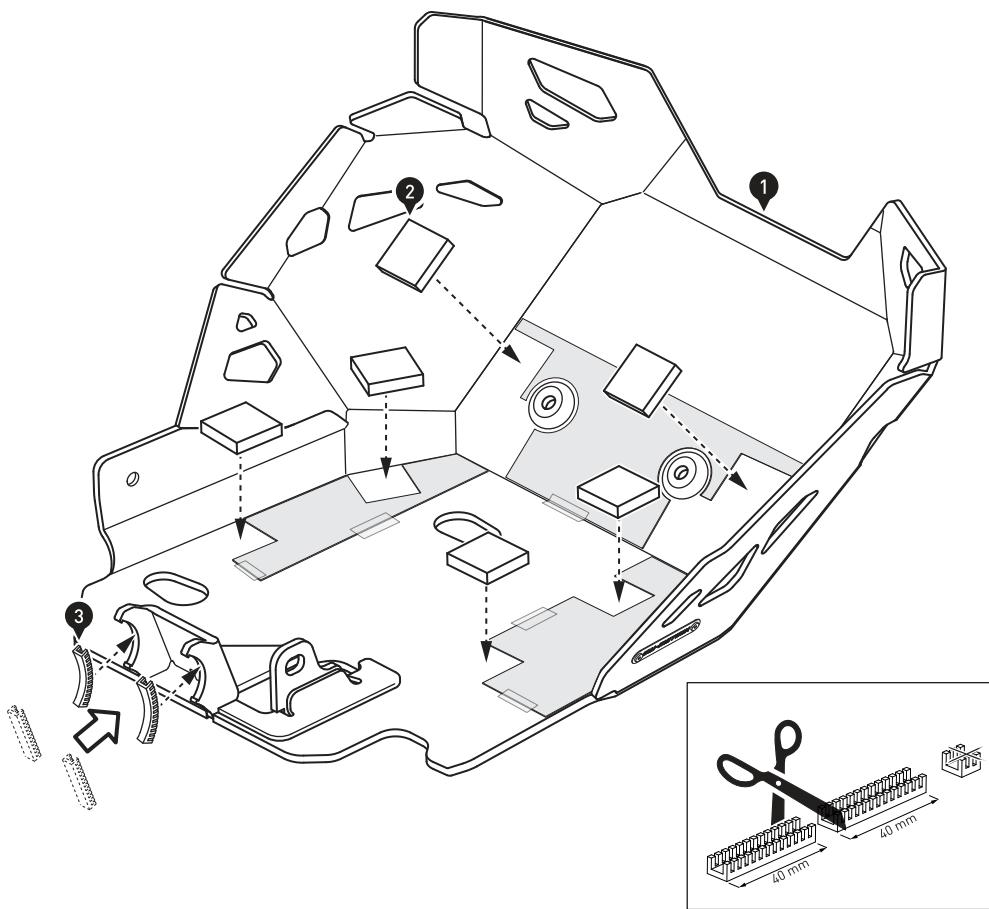
Kleben Sie Gummi-Elemente (2) mithilfe der angefügten Schablonen auf, wie in der Zeichnung gezeigt.
