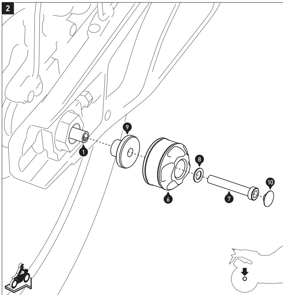
Montieren Sie das Achssturzpad anschließend auf der rechten Fahrzeugseite, wie in der Zeichnung gezeigt.
