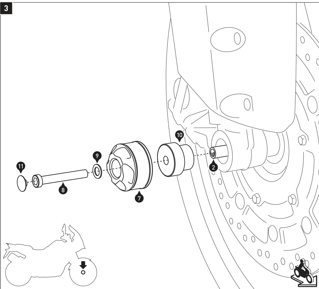
Montieren Sie das Achssturzpad anschließend auf der rechten Fahrzeugseite, wie in der Zeichnung gezeigt.
