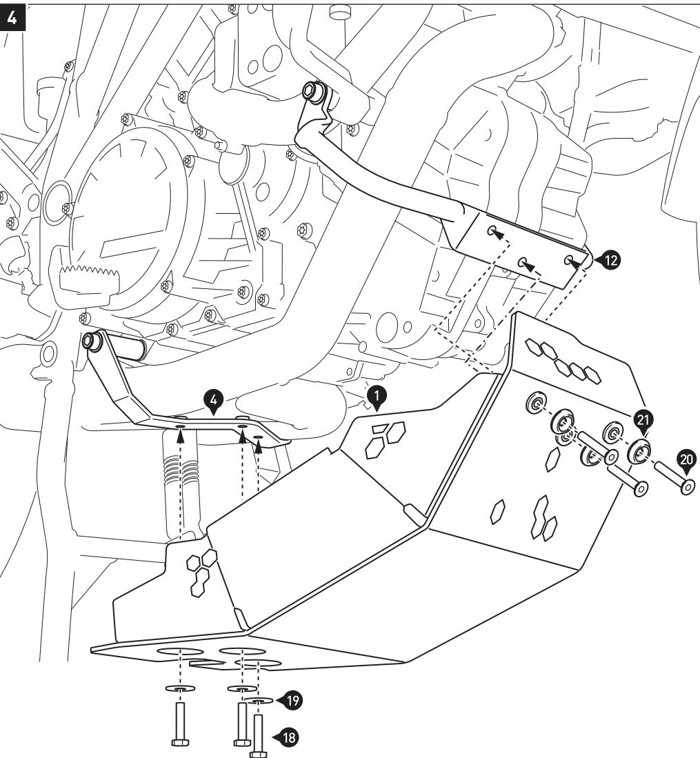
Verschrauben Sie den Motorschutz (1) an dem Anbaublech (4) und dem Montagebügel (12), wie in der Zeichnung gezeigt.
