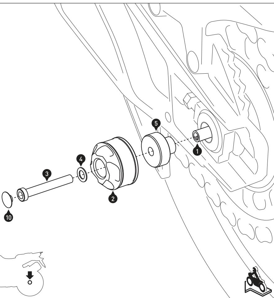
Montieren Sie das Achssturzpad auf der linken Fahrzeugseite, wie in der Zeichnung gezeigt.
