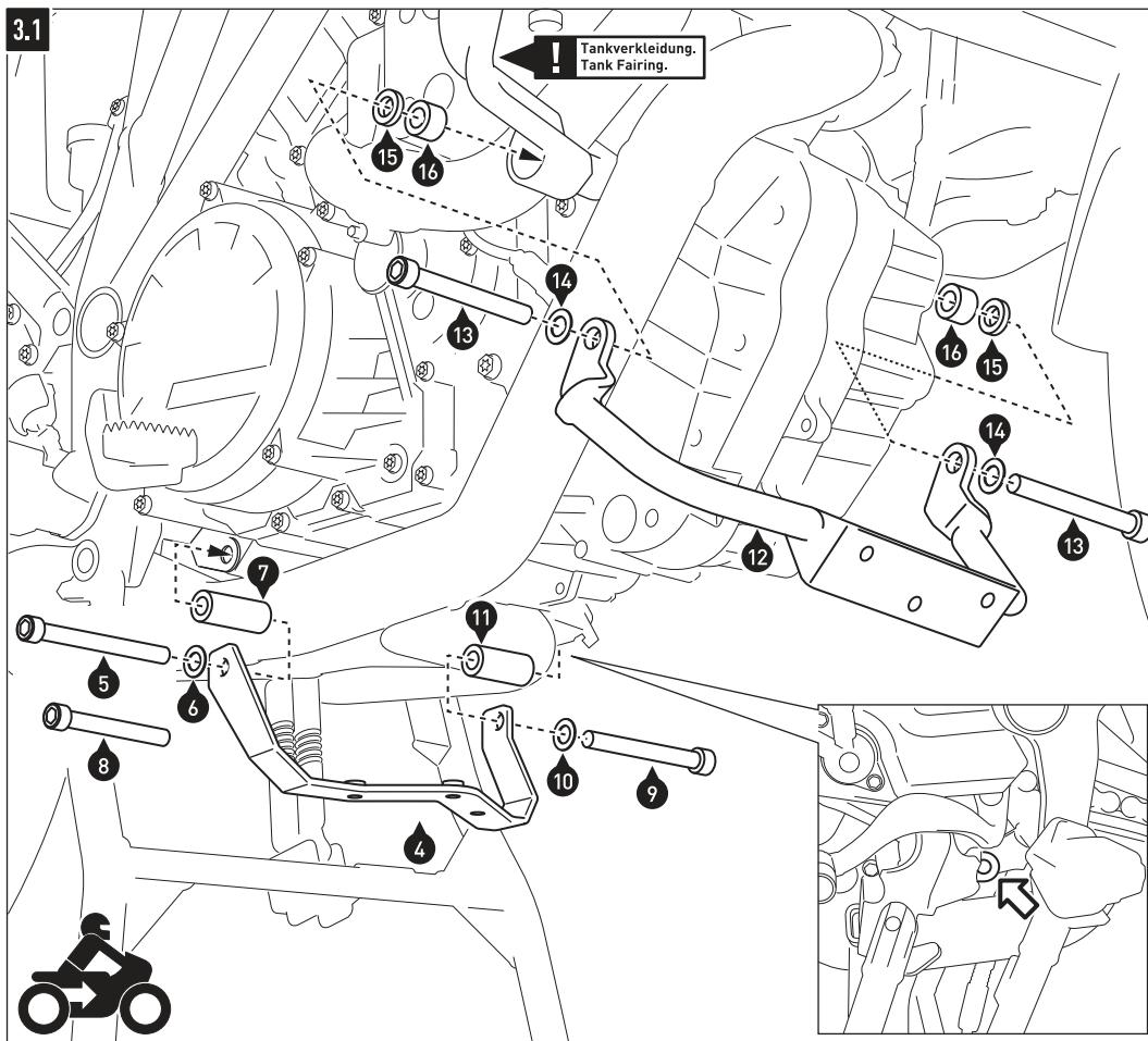
**Schritt 2.1: Montage mit den originalen Tankverkleidungen.**
