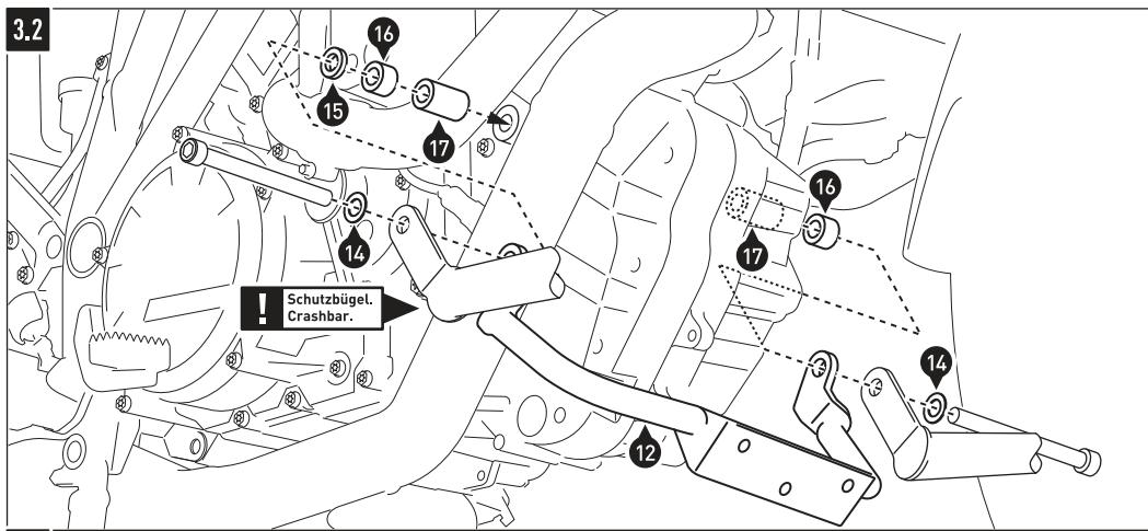
**Schritt 3.2: Montage mit dem SW-MOTECH Schutzbügel.**
