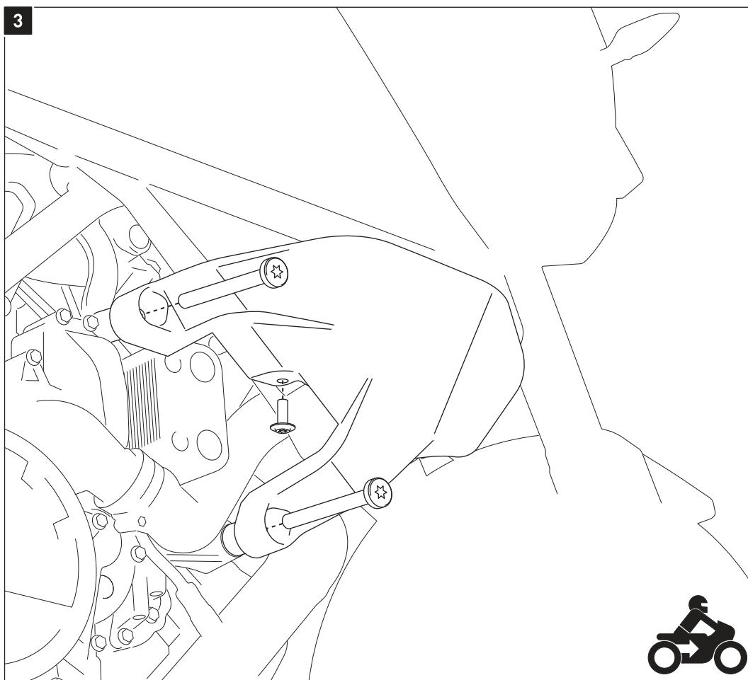
Entfernen Sie die gezeigten Schrauben der rechten Verkleidung und entfernen Sie diese vom Fahrzeug.
