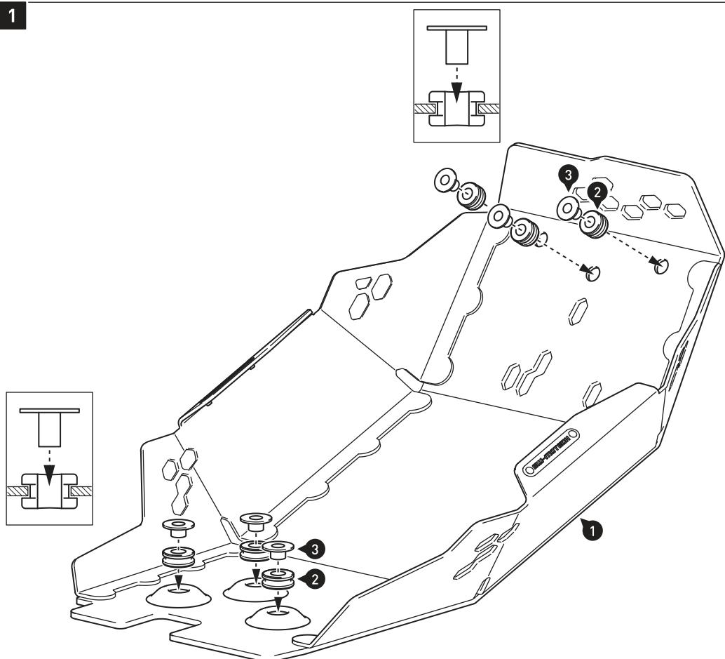
Setzen Sie die Gummitüllen (2) in die Öffnungen des Motorschutzes (1) ein, wie in der Zeichnung gezeigt. Drücken Sie anschließend die Bundbuchsen (3) in die Öffnungen der Gummitüllen (2).
