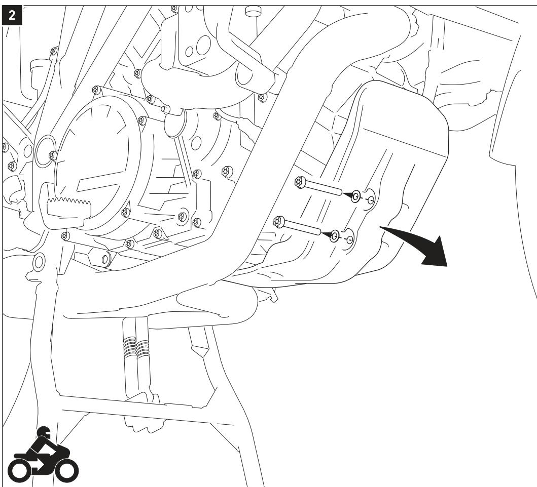
Lösen Sie die gezeigten Schrauben und entfernen Sie den originalen Unterbodenschutz vom Fahrzeug.
