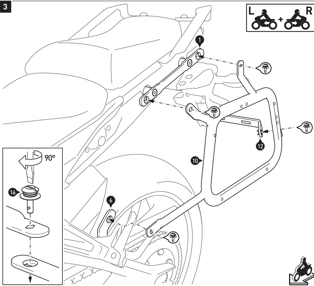
Verbinden Sie die beiden Kofferträger (10) und (11) mit den Befestigungslaschen (1) und (6); verwenden Sie die Schnellverschlüsse (16), wie in der Detailzeichnung gezeigt. Verbinden Sie nun die hinteren Befestigungsausleger mit dem Querverbinder (12). Benutzen Sie auch hier die Schnellverschlüsse (16).
