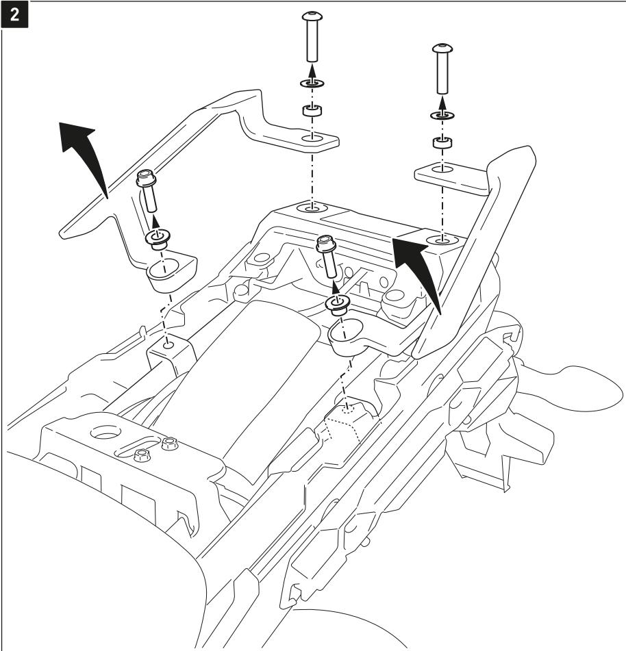
Lösen Sie die gezeigten Schrauben; entfernen Sie anschließend die Soziushaltegriffe und die gezeigten originalen Anbauteile.
