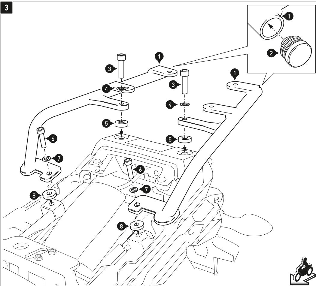
Verschrauben Sie die Rohrstrebens (1) am Fahrzeug, wie in der Zeichnung gezeigt.
