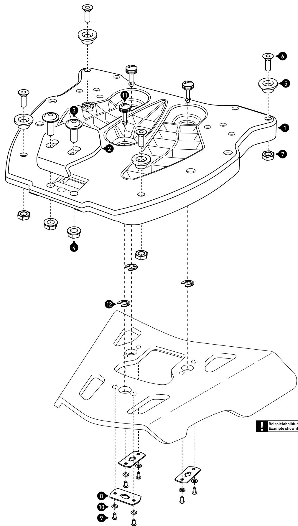
Montieren Sie die gezeigten Komponenten an der Adapterplatte (1) und ALU-RACK (nicht im Lieferumfang enthalten). Ziehen Sie die Schrauben wie in der Stückliste vorgegeben an.
