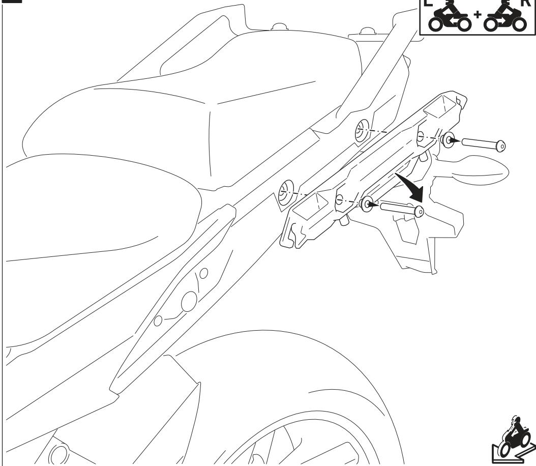
Entfernen Sie beidseitig die originalen Kofferaufnahmen vom Fahrzeug.
