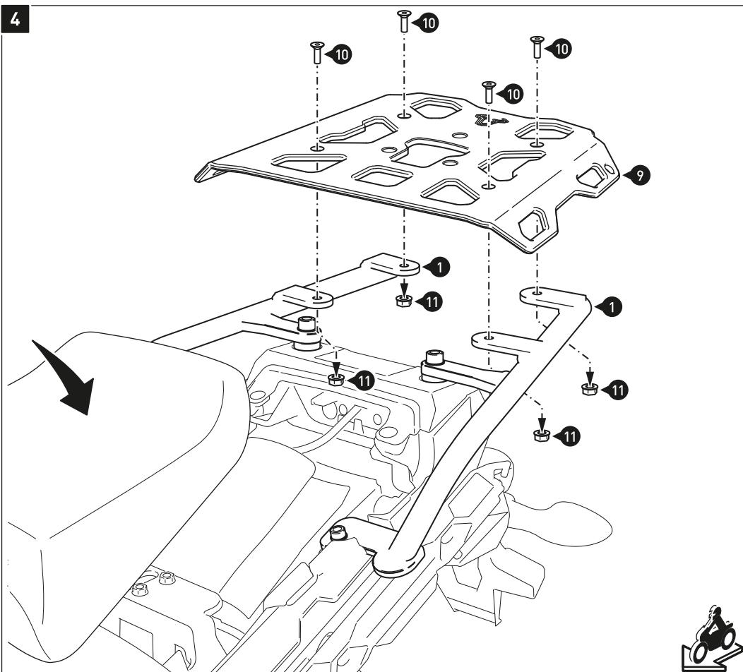
**HINWEIS:** Falls die Montage einer QUICK-LOCK Adapterplatte vorgesehen ist, sollten die Haltenocken am ALU-RACK vor dessen Anbau am Fahrzeug verschraubt werden.
