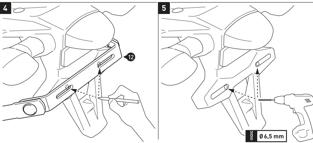
**HINWEIS:** Führen Sie die Schritte 4 & 5 nur durch, falls die Montagebohrungen des Kotflügels nicht mit dem Lochbild des Querverbinders (12) übereinstimmen.
