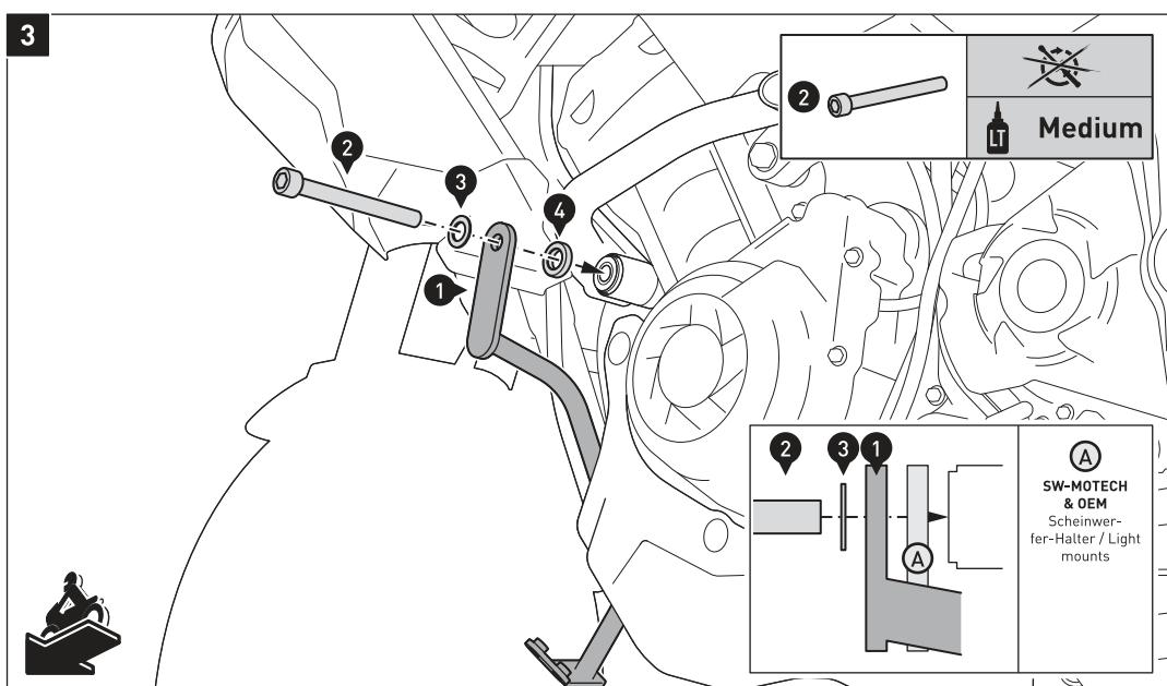
**HINWEIS:** Die Distanzbuchse (4) entfällt bei gleichzeitiger Montage mit dem SW-MOTECH Scheinwerfer-Halter und dem original Scheinwerferhalter.
