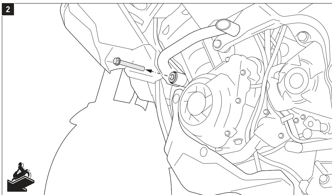
Entfernen Sie die gezeigte Schraube auf der **linken** Fahrzeugseite.
