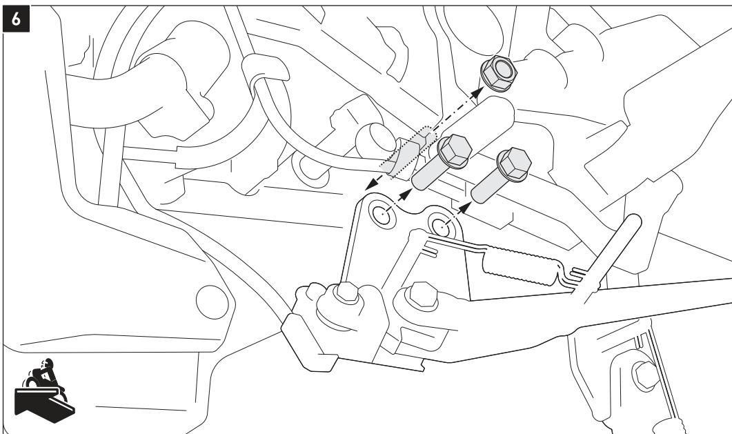
Entfernen Sie die gezeigte Schrauben und die Mutter auf der **linken** Fahrzeugseite.
