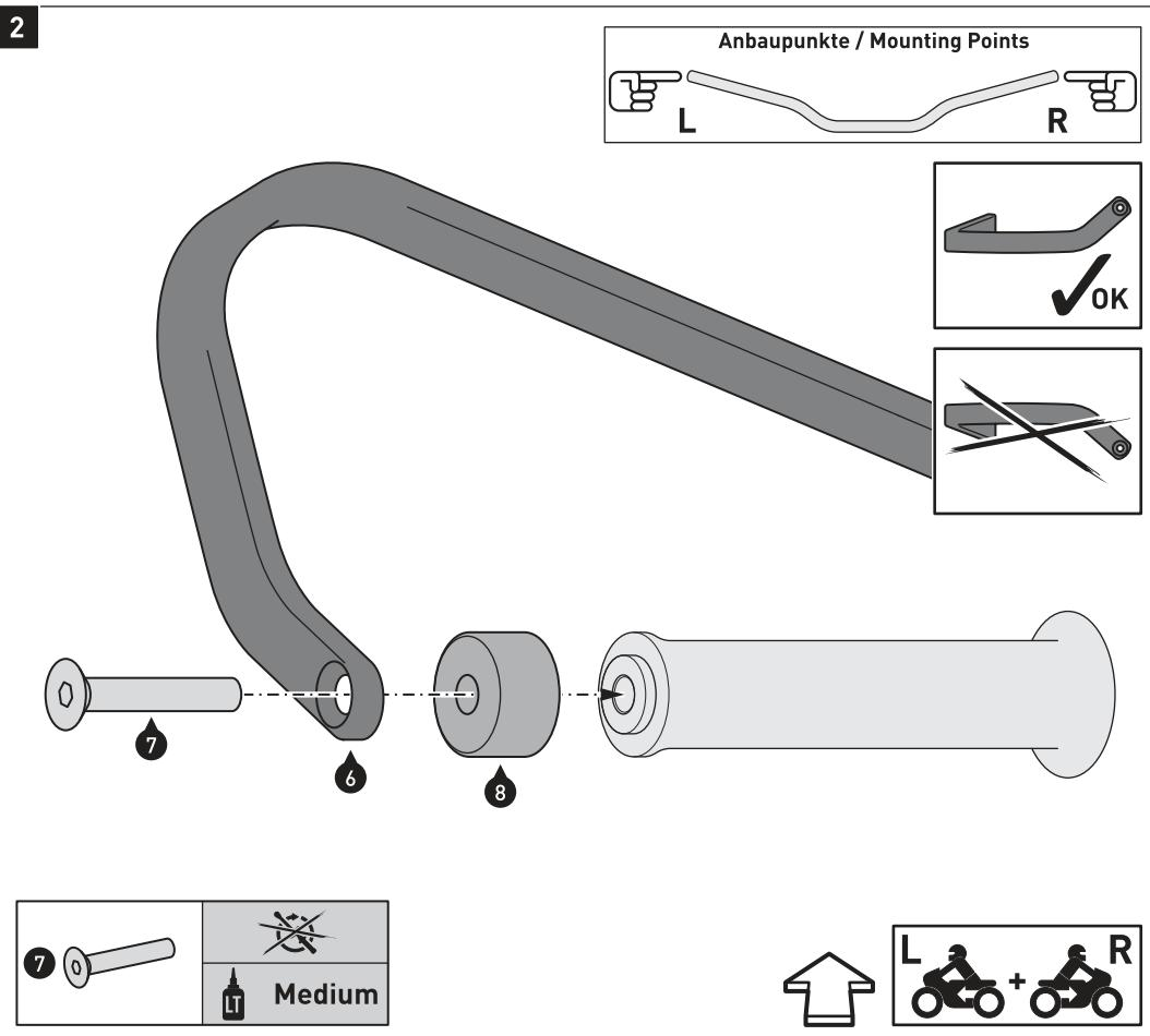
Montieren Sie die Bügel (6) beidseitig an den Lenkerenden, wie in der Zeichnung gezeigt.
