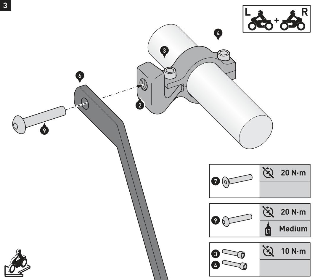
Montieren Sie die innenliegenden Enden der Bügel (6) an den Verbindungsstücken (2).
