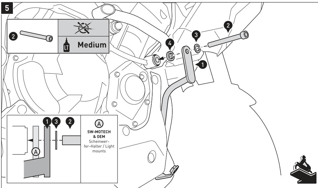
**HINWEIS:** Die Distanzbuchse (4) entfällt bei gleichzeitiger Montage mit dem SW-MOTECH Scheinwerfer-Halter und dem original Scheinwerferhalter.
