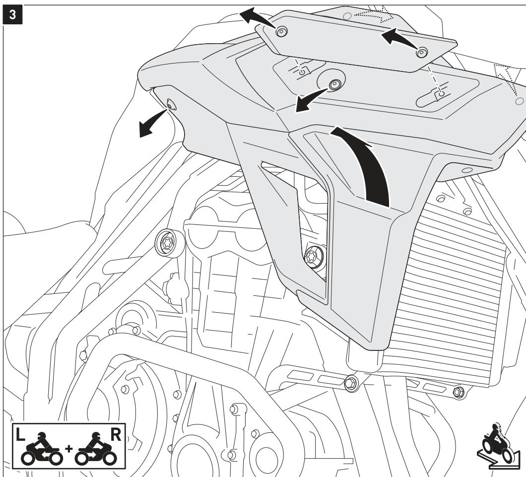
Lösen Sie die markierten Schrauben der rechten Seitenverkleidung (zwei Schrauben innenliegend). Entfernen Sie die Seitenverkleidung vom vorsichtig vom Fahrzeug (push upwards).
