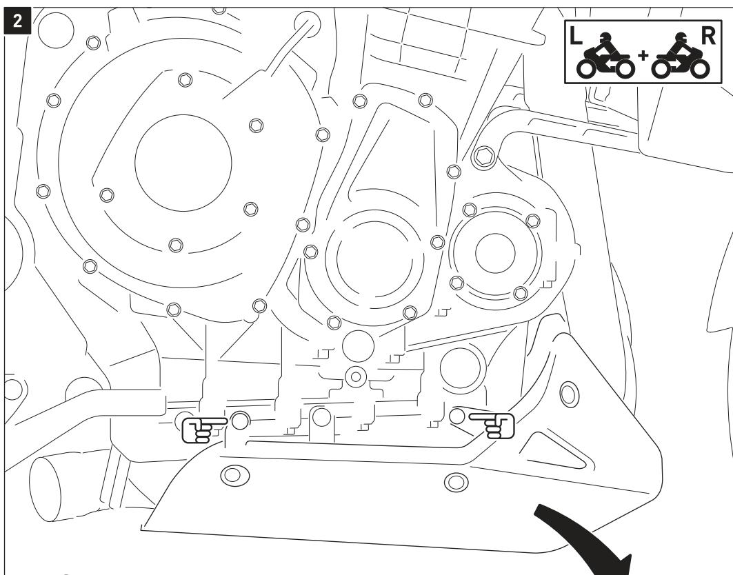
Lösen Sie beidseitig die markierten Schrauben und entfernen Sie den originalen Motorschutz vom Fahrzeug.
