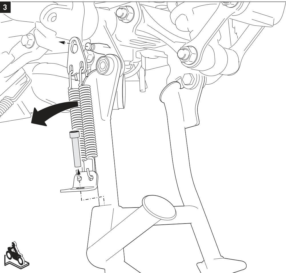
Lösen Sie die markierte Schraube des Haupständers-Federsatzes und entfernen Sie diesen vom Fahrzeug.
