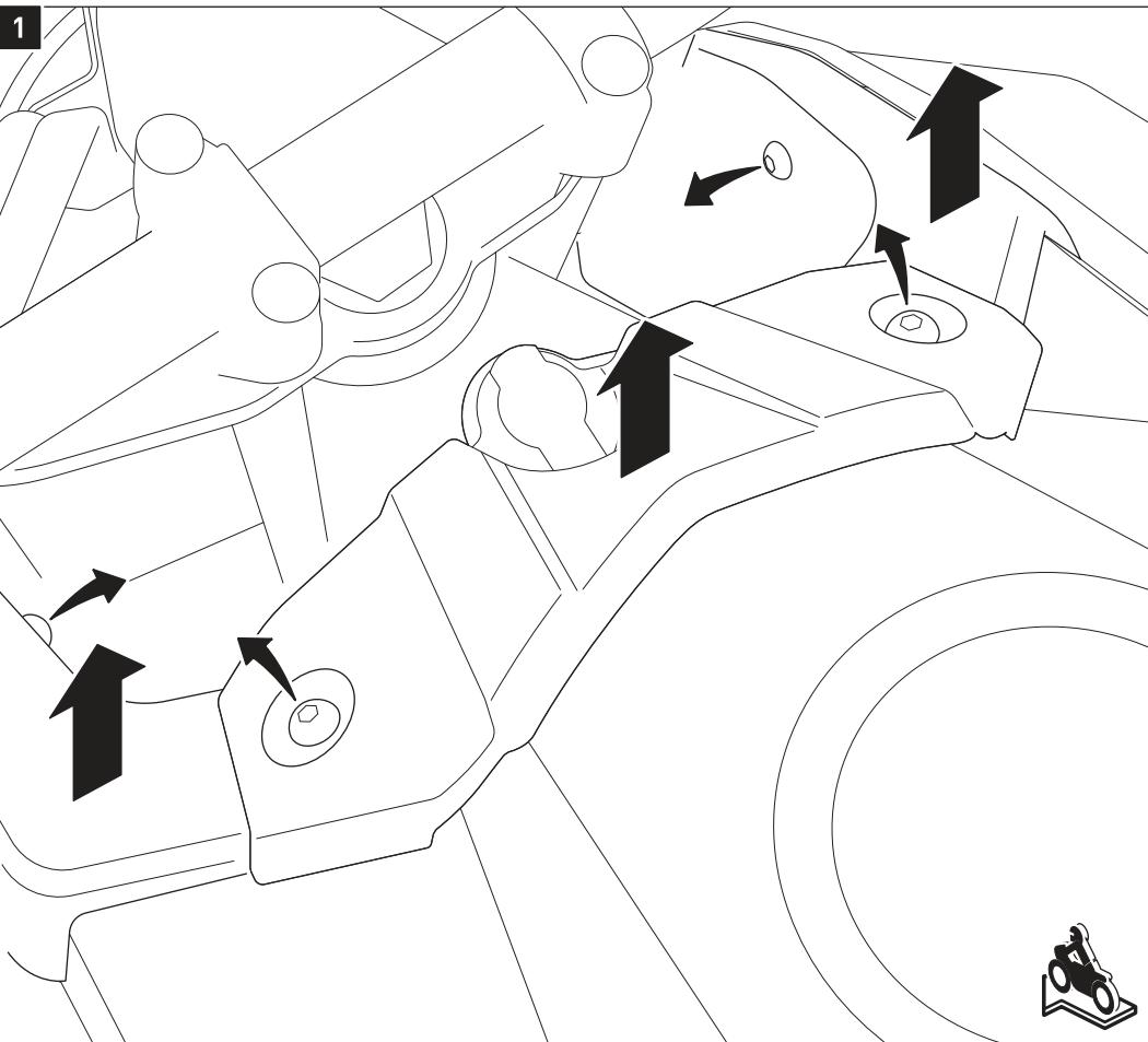
Lösen Sie die gezeigten Schrauben und entfernen Sie die mittlere Tankverkleidung.
