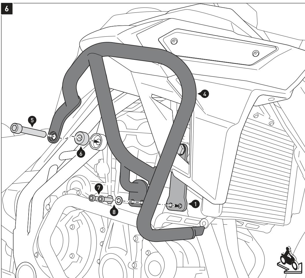
Verschrauben Sie den rechten Schutzbügel (4) am Fahrzeug, wie in der Zeichnung gezeigt.
