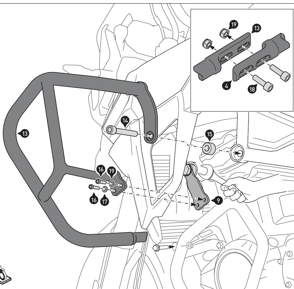
Verschrauben Sie den linken Schutzbügel (13) am Fahrzeug, wie in der Zeichnung gezeigt.
