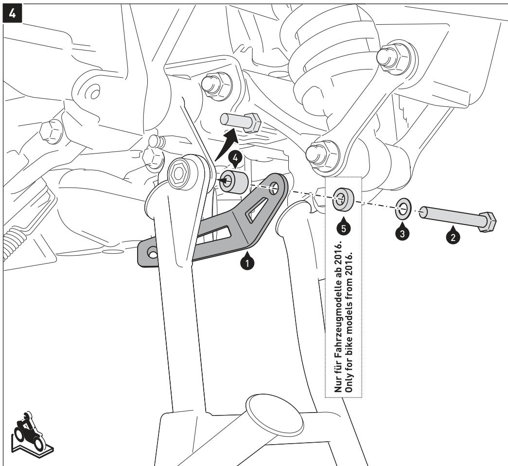
Entfernen Sie die gezeigte originale Schraube (Innenseite der Hauptständeraufnahme).
