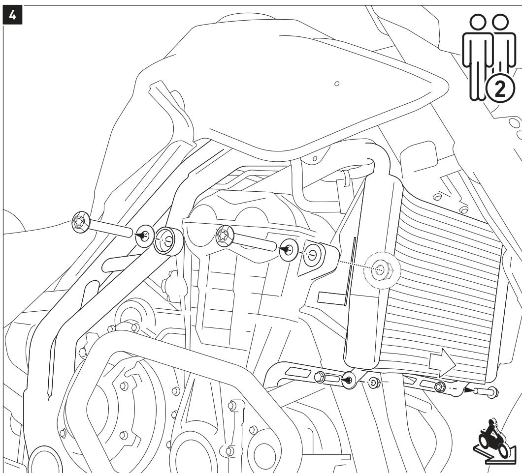
**HINWEIS:** Lassen Sie sich bei der Demontage der Mutter von einer zweiten Person helfen. Verwenden Sie eine Umschaltknarre mit Verlängerung und Gelenkstück, um die Mutter von der linken Fahrzeugsseite zu lösen.
