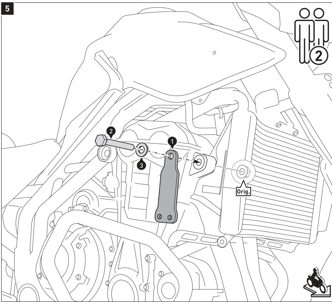
Montieren Sie das Anbaublech (1) mit der originalen Mutter (Orig.) am Fahrzeugrahmen, wie in der Zeichnung gezeigt.
