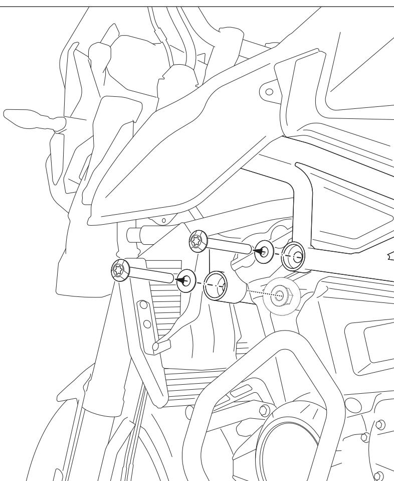
Entfernen Sie die gezeigten originalen Schrauben, Unterlegscheiben und die Mutter vom Fahrzeugrahmen.
