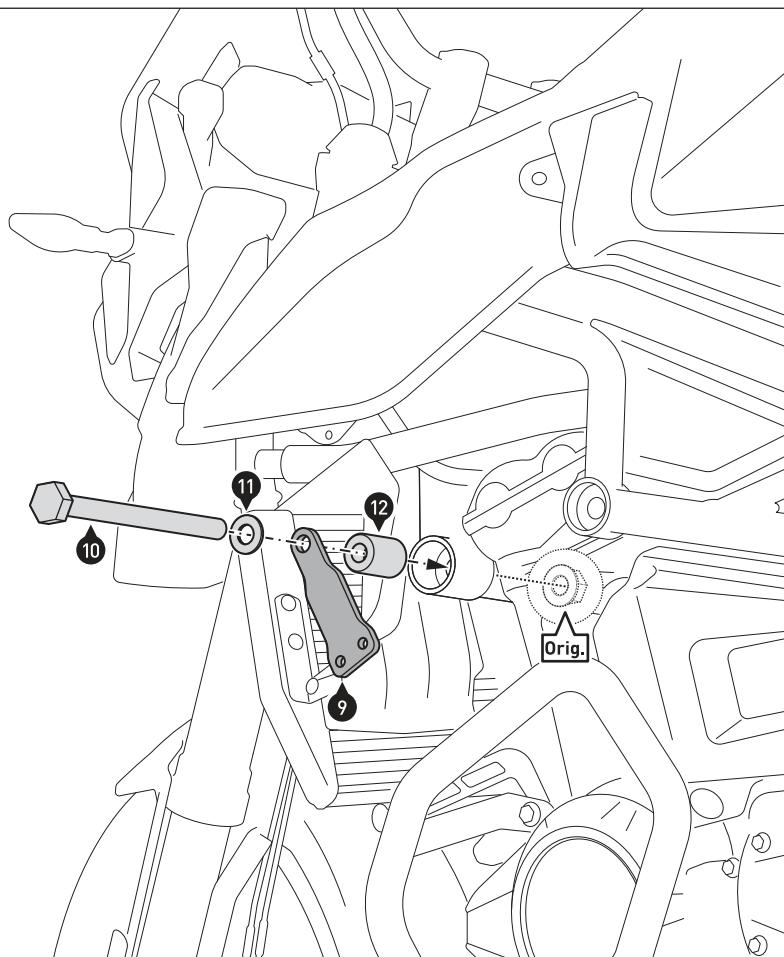
Montieren Sie das Anbaublech (9) mit der originalen Mutter (Orig.) am Fahrzeugrahmen, wie in der Zeichnung gezeigt.
