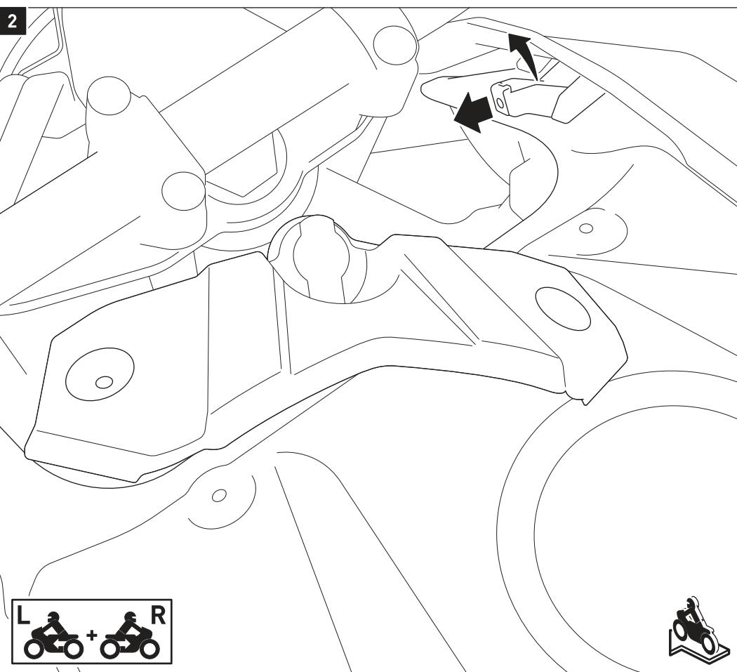
Lösen Sie beidseitig die Schrauben der Verkleidungshalter.
