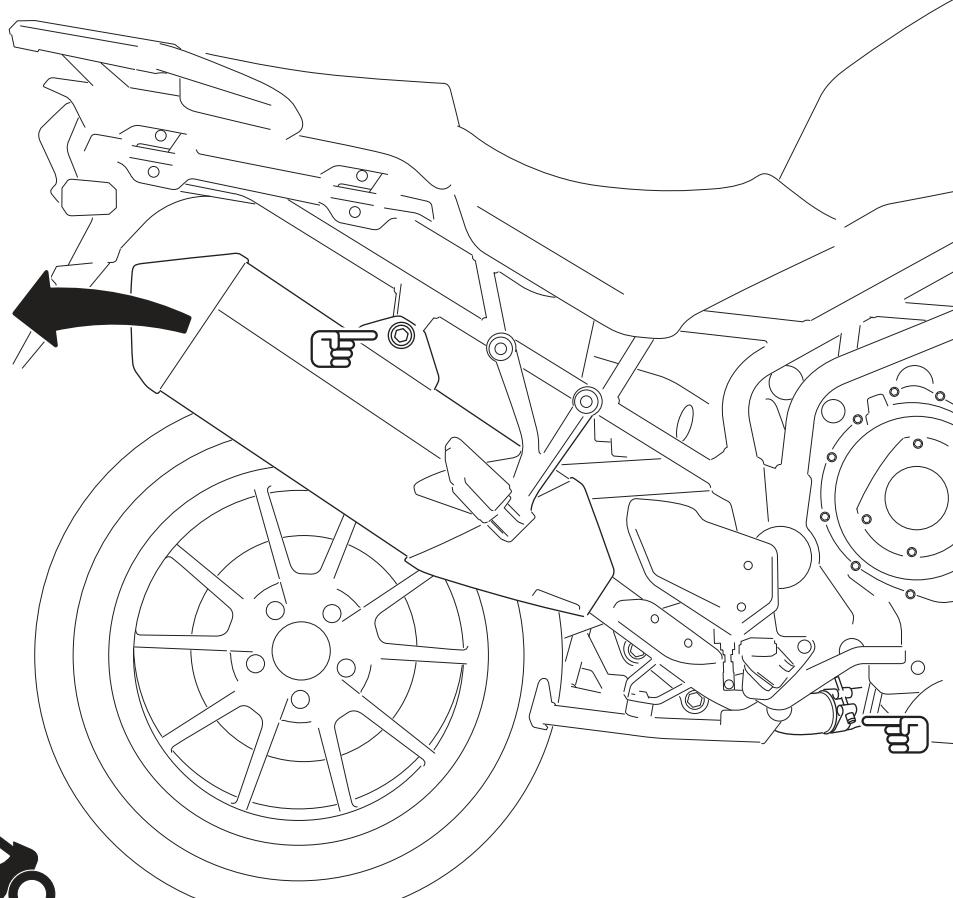
Lösen Sie auf der rechten Fahrzeugseite die markierten Schrauben und entfernen Sie den Schalldämpfer vom Fahrzeug.
