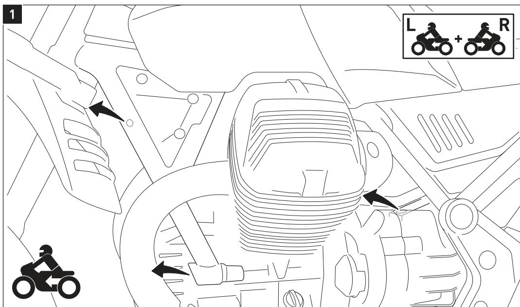
Entfernen Sie die Kunststoffdübel von den Rahmengewinden, sowie die Motorhalteschrauben, wie in der Zeichnung gezeigt.
