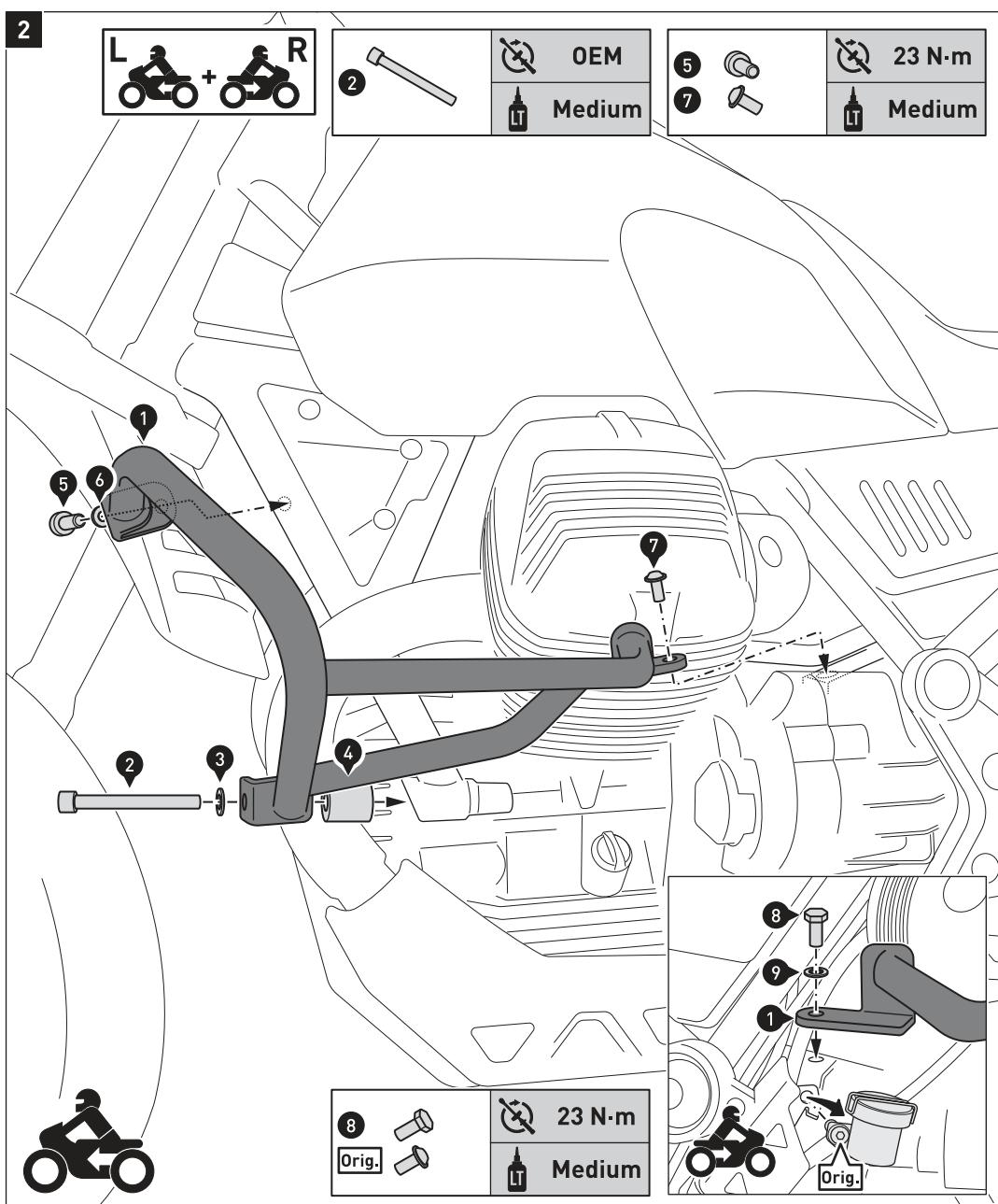
Verschrauben Sie die Sturzbügel (1) auf beiden Seiten des Fahrzeugs, wie in der Zeichnung gezeigt.
