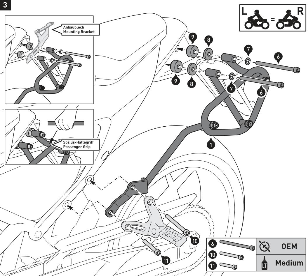
**HINWEIS:** Bei gleichzeitiger Verwendung des SW-MOTECH Gepäckträgers entfallen die Distanzbuchsen (8). Montieren Sie an deren Stelle das Anbaublech des Gepäckträgers, wie in der oberen Detailzeichnung gezeigt.
