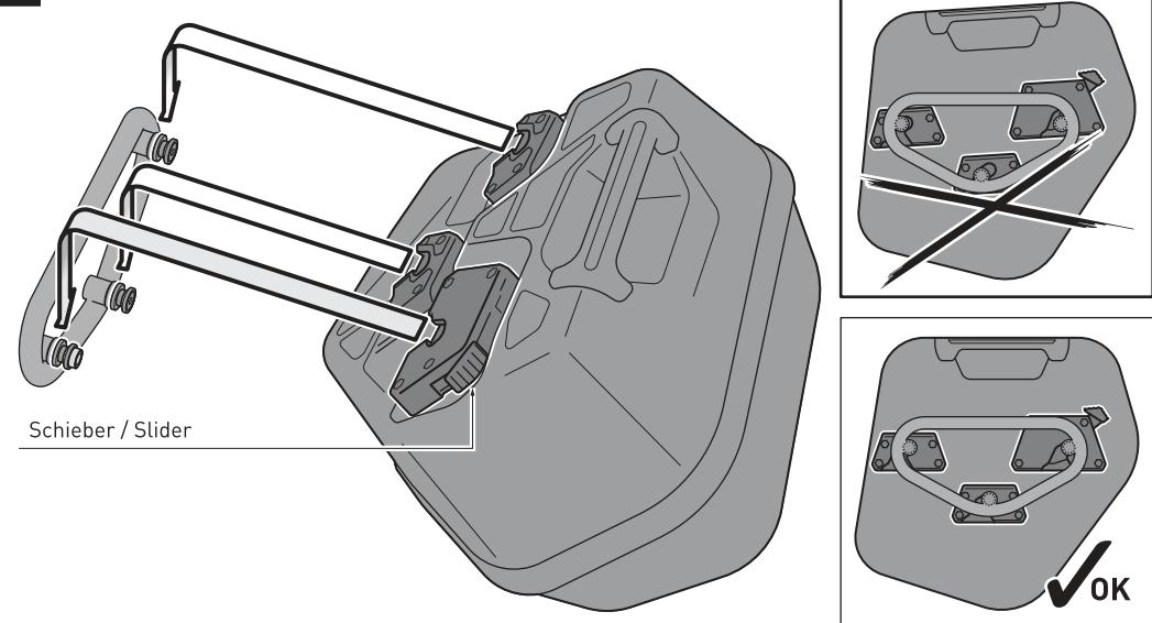
Setzen Sie die drei Arretierungsöffnungen des Seitenkoffers auf die Führungsbolzen des montierten SLC Seitenträgers. Drücken Sie anschließend den Seitenkoffer leicht nach unten, bis dieser fest am SLC Seitenträger sitzt.
