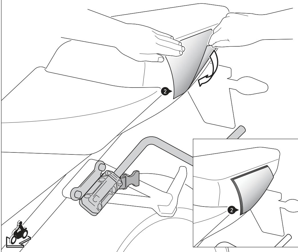
**ES** - Tras montar la estructura de las alforjas, se debe proteger la superficie de la motocicleta de posibles ralladuras con la lámina protectora que se incluye (2).
