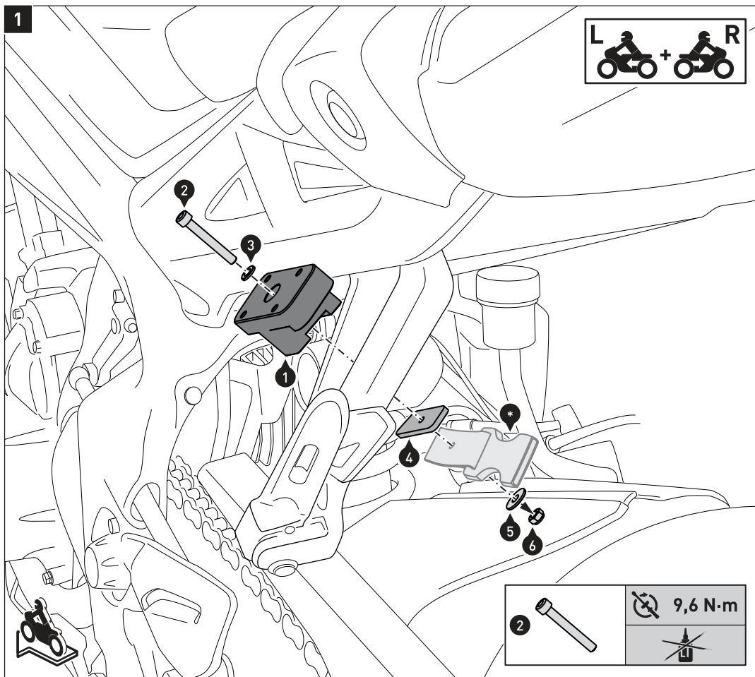
Montieren Sie die gezeigten Teile an den Soziusfußrasten.
