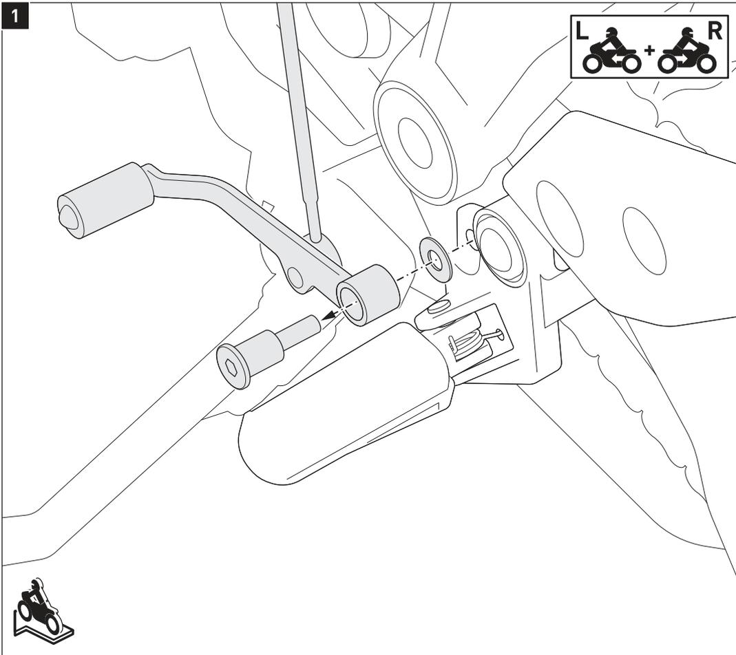
Lösen Sie die gezeigte Schraube und entfernen Sie den Schalthebel vom Fahrzeug.
