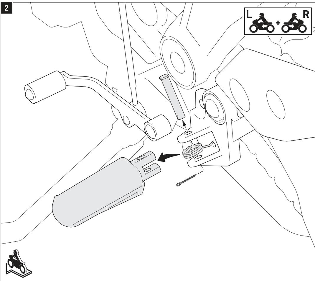
Entfernen Sie beidseitig die original Fußrasten vom Fahrzeug.
