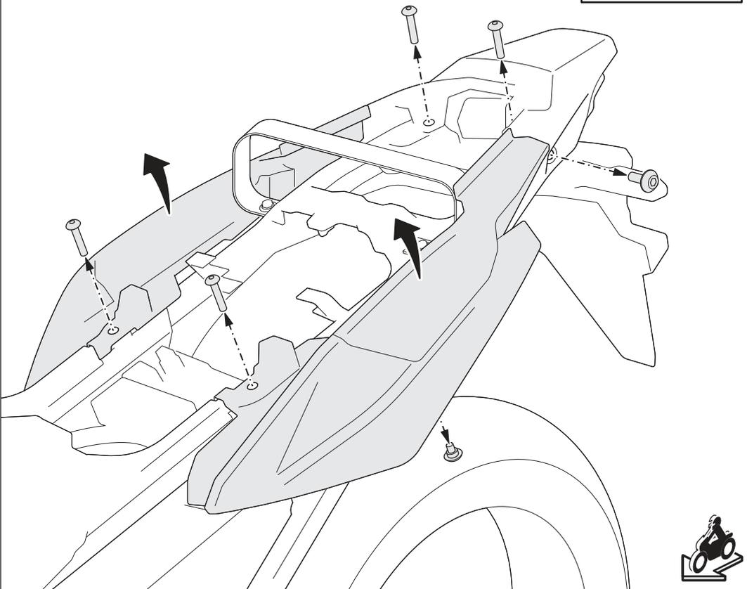
Entfernen Sie beidseitig die gezeigten Schrauben und anschließend die hinteren Seitenverkleidungen vom Fahrzeug. Achten Sie dabei auf die Kunststoffhaken der Seitenverkleidungen.
