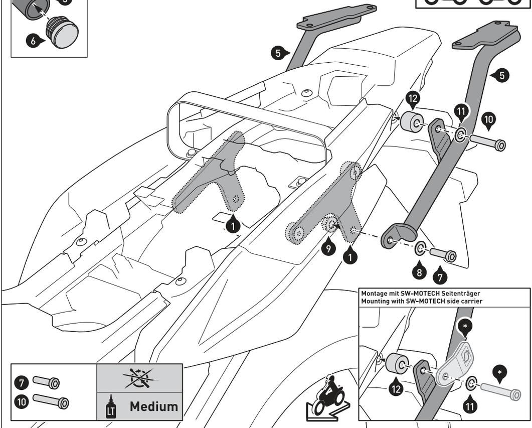
**HINWEIS:** Wenn der Gepäckträger mit dem SW-MOTECH Seitenträger montiert wird, entfallen die Schrauben (10). Montieren Sie stattdessen die markierten (\*) Teile des Gepäckträgers, wie in der Detailzeichnung gezeigt.
