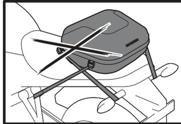
**Schritt [8]:** Befestigen Sie nun die Hakenschnallen der VIER Schlaufgurte (11) beidseitig an den in der Zeichnung gezeigten Schlaufen des Topcase (1). Ziehen Sie alle Befestigungsgurte an, bis das Topcase (1) zentriert und fest am Fahrzeug befestigt ist.
