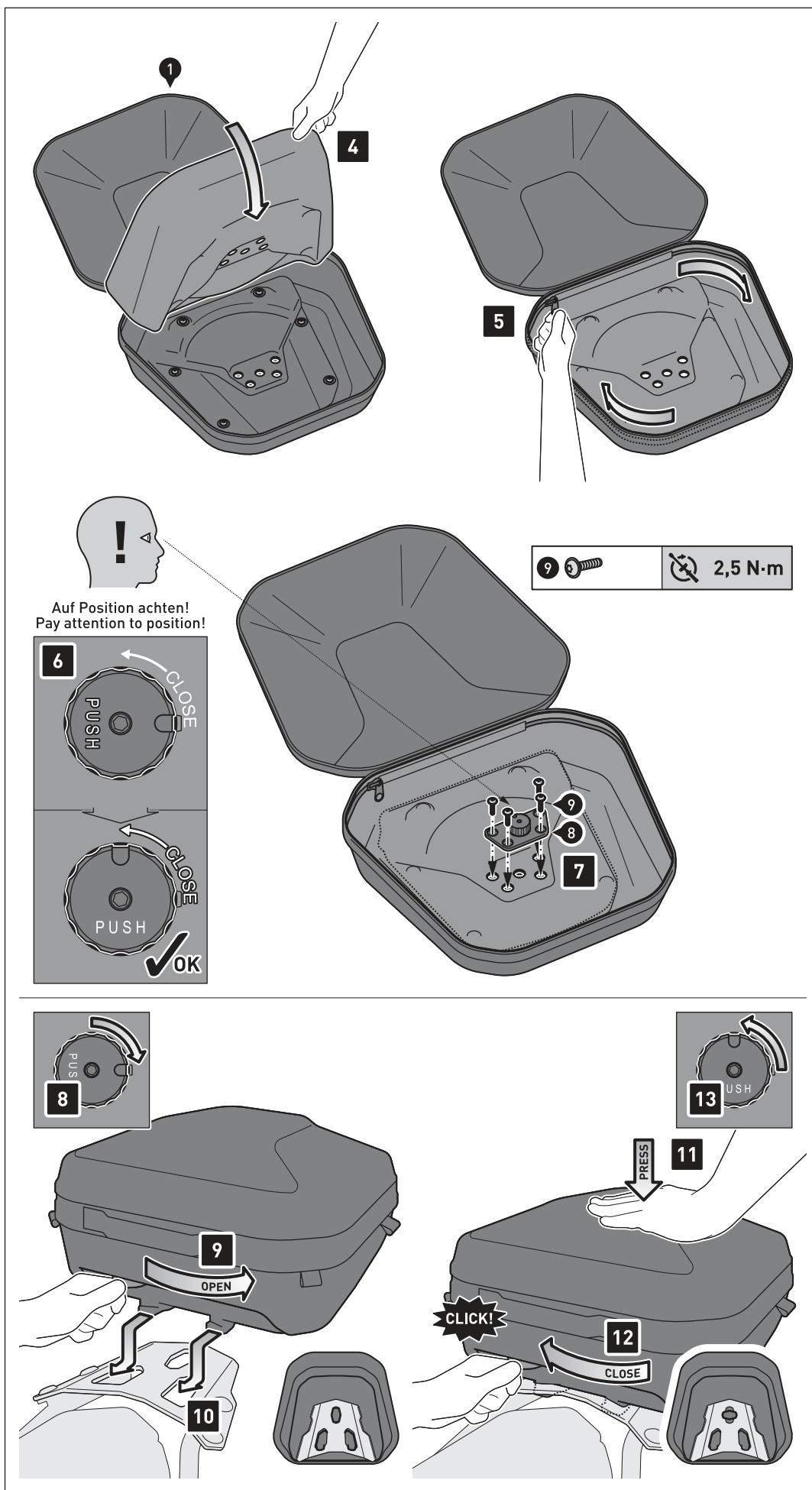
**Schritt [4]:** Klappen Sie die Innenverkleidung nach unten.
