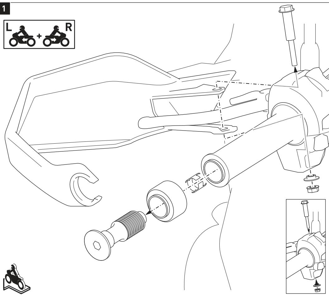
Entfernen Sie, falls montiert, die originalen Handprotektoren und Lenkerendgewichte vom Fahrzeug.
