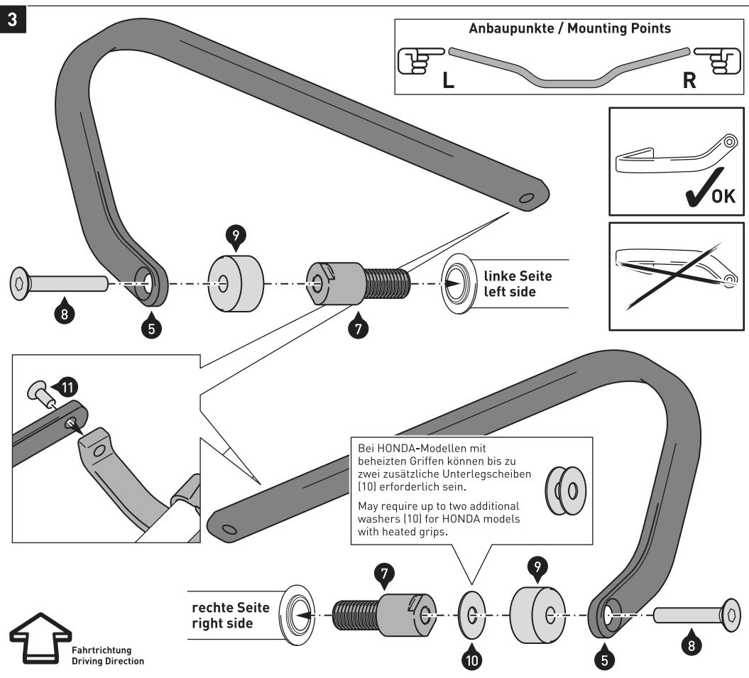
Montieren Sie die Adapter (7) an den Lenkerenden und ziehen Sie diese wie in der Stückliste vorgegeben an.
