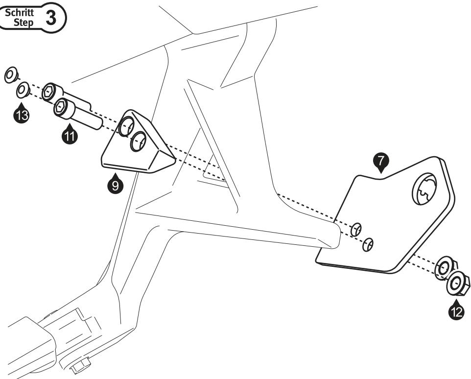
Verschrauben Sie die Befestigungslaschen (7) und (8) beidseitig an den Soziusfußrasten. Die Montage erfolgt seitengleich.
