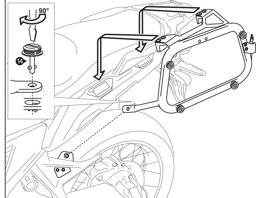
Hängen Sie beidseitig die Seitenträger (5) und (6) in die dafür vorgesehenen Halteöffnungen des Fahrzeugs ein. Verbinden Sie die Seitenträger an den Befestigungslaschen (7) und (8) mit den Schnellverschlüssen (14).
