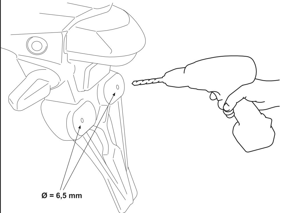
Bohren Sie mit einem 6,5-mm-Bohrer die Befestigungsbohrungen des Querverbinders (15). Entgraten Sie anschließend die Ränder der Befestigungsbohrungen.
