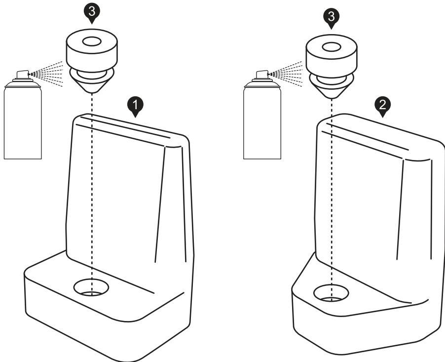
Fetten Sie die Vibrationsdämpfer (3) mit etwas Silikonspray ein. Setzen Sie anschließend die Vibrationsdämpfer (3) in die dafür vorgesehenen Öffnungen der Einschubnasen (1) und (2) ein.
