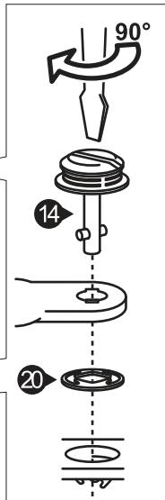
Hängen Sie beidseitig die Seitenträger (5) und (6) in die dafür vorgesehenen Halteöffnungen des Fahrzeugs ein (siehe Schritt 4). Verbinden Sie die Seitenträger an den Befestigungslaschen (7) und (8) und dem Querverbinder (15) mit den Schnellverschlüssen (14). Sichern Sie die Schnellverschlüsse (14) mit den Sicherungsscheiben (20).
