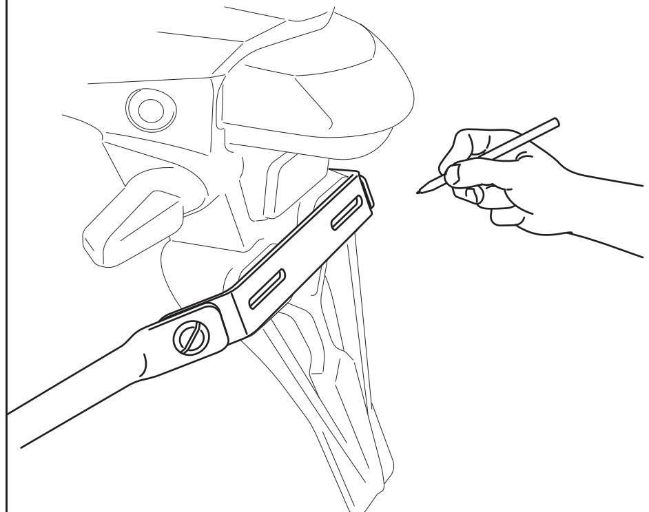
Markieren Sie mit einem geeigneten Stift die Befestigungsbohrungen des Querverbinders (15). Lösen Sie anschließend die Schnellverschlüsse und entfernen Sie den Querverbinder (15) vom Fahrzeug.
