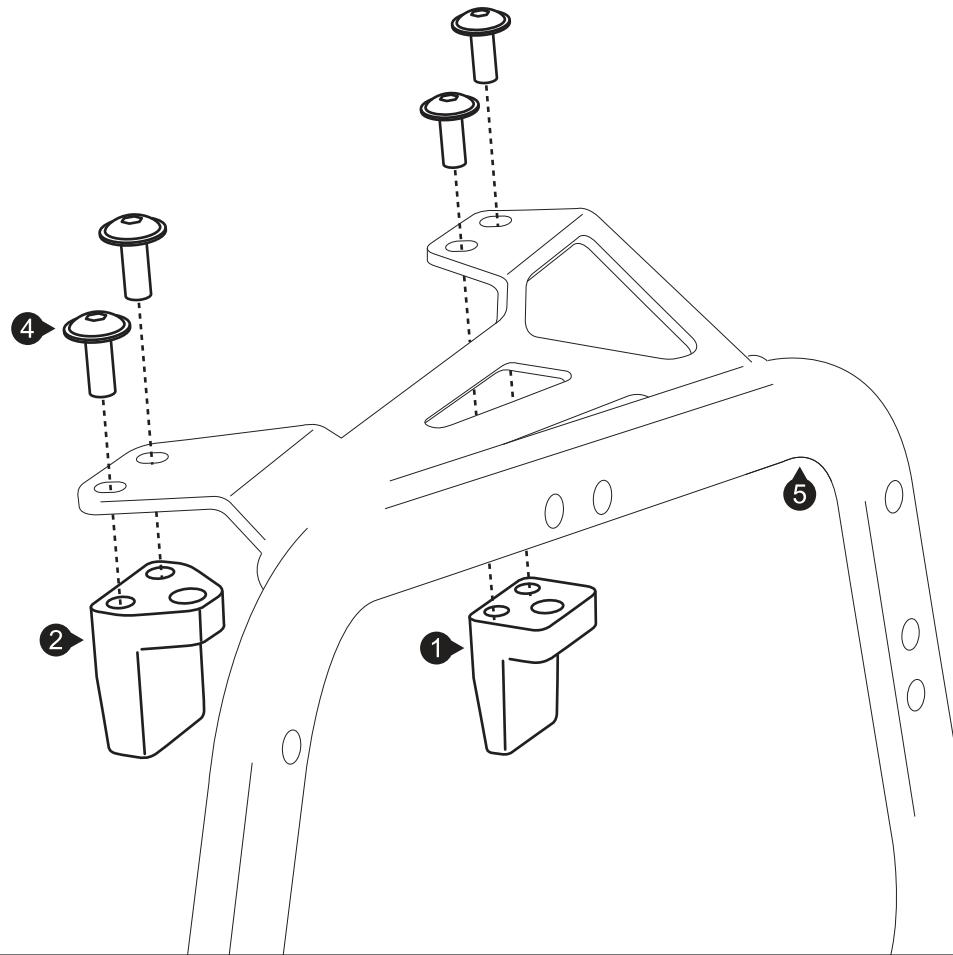
Verschrauben Sie die Einschubnasen (1) und (2) an den Seitenträgern (5) und (6). Die Montage erfolgt seitengleich.
