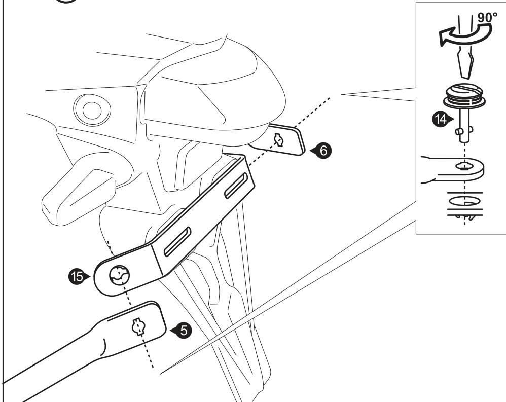
Verbinden Sie die beiden Seitenträger (5) und (6) an den hinteren Befestigungsauslegern mit dem Querverbinder (15). Benutzen Sie auch hier die Schnellverschlüsse (14).
