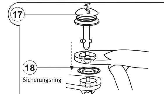
Zur Demontage des QUICK-LOCK-Kofferträgers einfach mit einer Münze oder einem Schraubendreher die Schnellverbinder lösen und Seitenträger entfernen.
