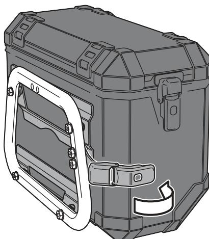
Anschließend den Spannverschluss der TRAX ION M / L wie gezeigt am Vorspannwinkel einhängen und umklappen.
