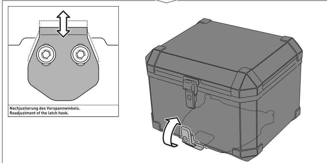
Anschließend den Spannverschluss des TRAX ION Topcase wie gezeigt am Vorspannwinkel einhängen und umklappen.
