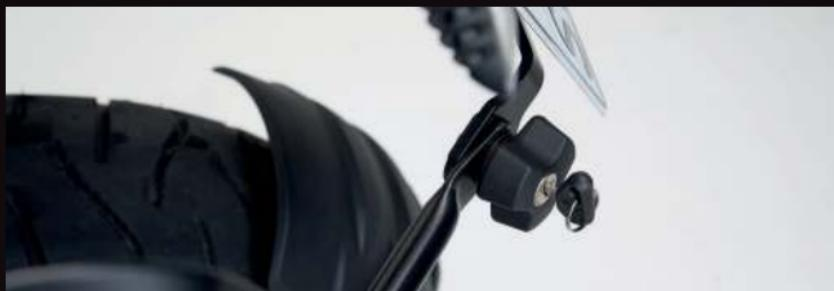
Satz mit zwei gleichschließenden Schlossern und Schlüsseln zur Absicherung eines PRO Seitenträgers gegen Diebstahl. Das Schloss wird an einem Befestigungspunkt der QUICK-LOCK Halterung anstelle des Schnellverschlusses angebracht.
