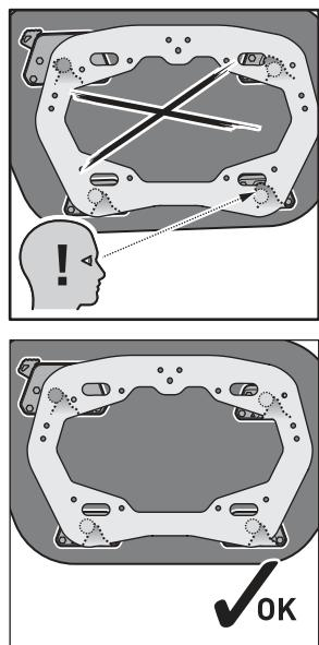
**Schritt [1]:** Setzen Sie die vier Arretierungsöffnungen des Seitenkoffers (1) auf die Führungsbolzen des montierten SW-MOTECH Seitenträgers.
