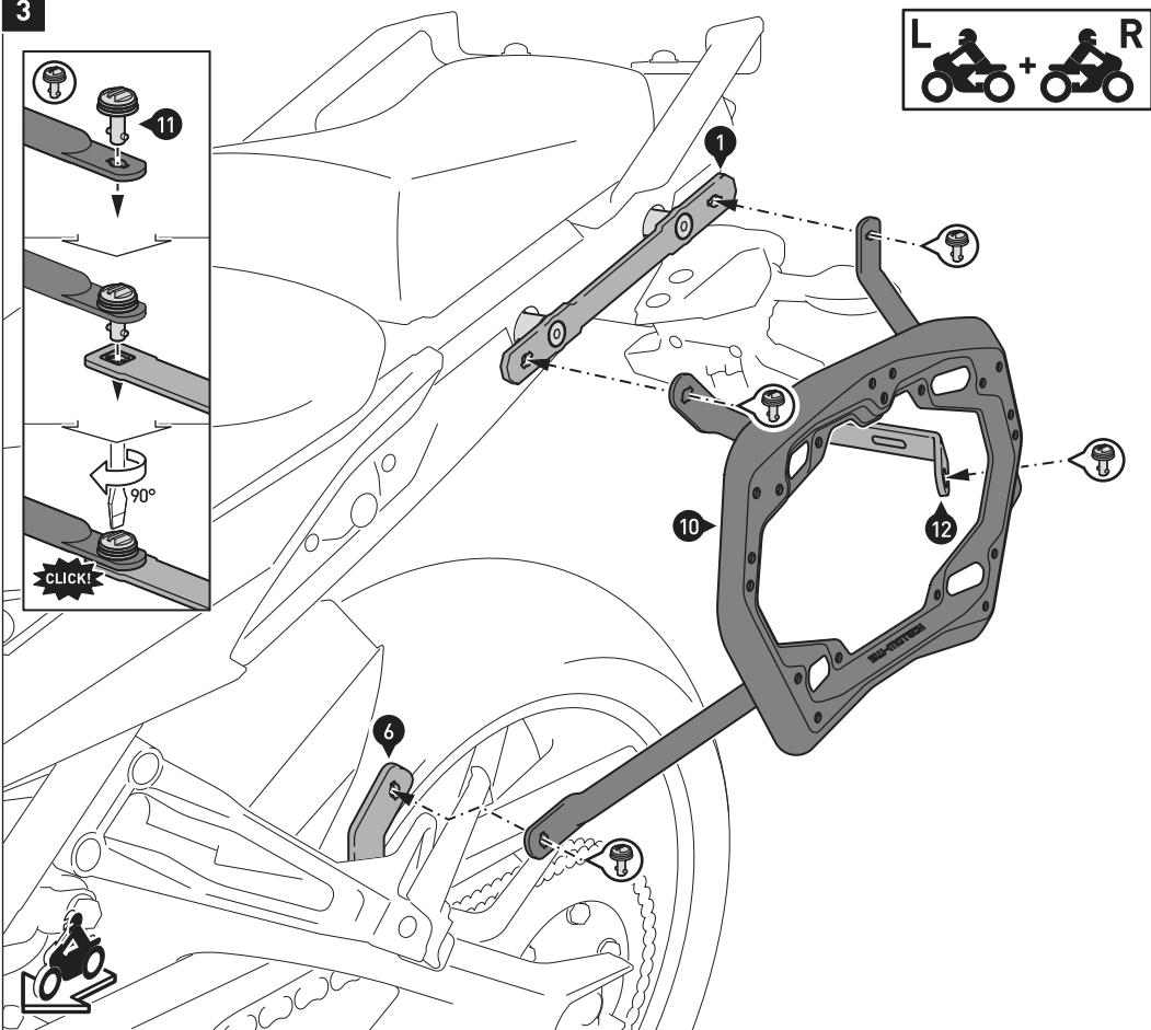
Verbinden Sie die beiden Seitenträger [10] mit den Befestigungslaschen [1] und [6]; verwenden Sie die Schnellverschlüsse [11], wie in der Detailzeichnung gezeigt.
