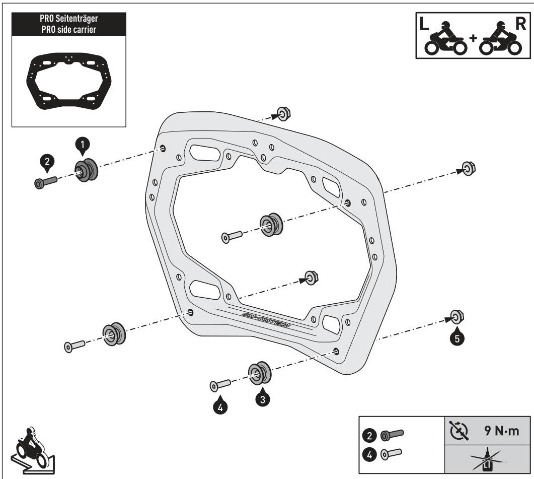
**HINWEIS:** Die Zeichnung zeigt die Montage am **rechten** PRO-Seitenträger. Montieren Sie die Teile am linken PRO-Seitenträger auf die gleiche Weise wie am rechten PRO-Seitenträger.
