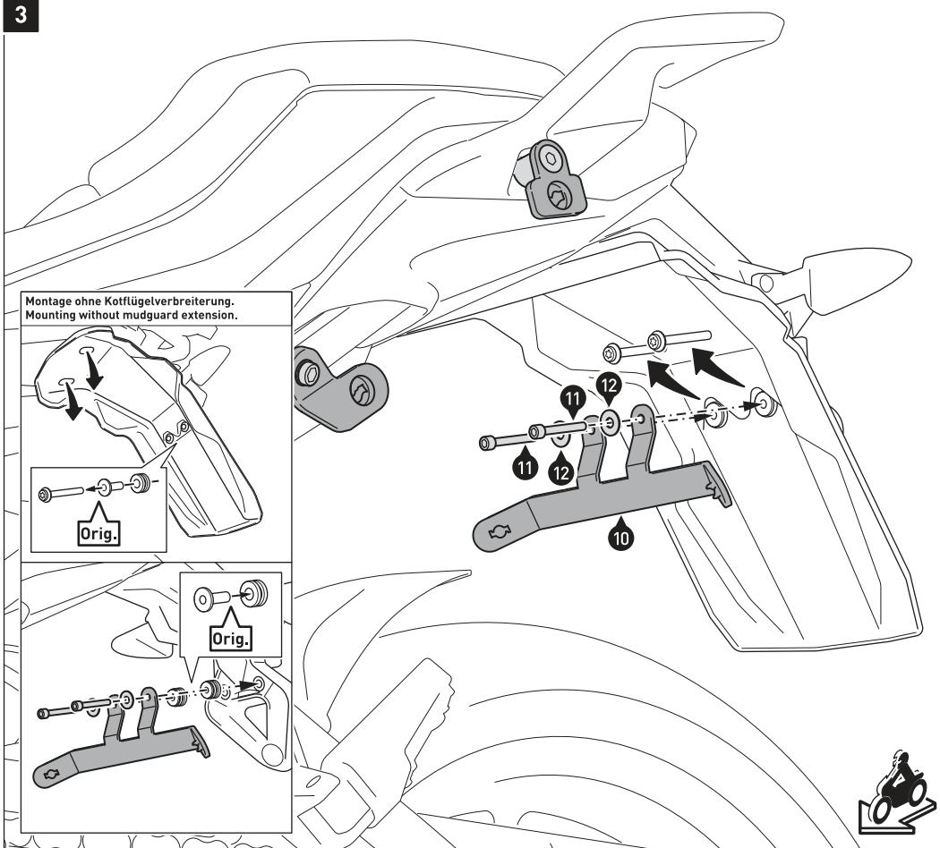
**HINWEIS:** Der Querverbinder (10) kann auch ohne die gezeigte Kotflügelverbreiterung montiert werden. Verwenden Sie in diesem Fall die originalen Bundbuchsen und Gummityllen als Abstandshalter, wie in den Detailzeichnungen gezeigt. Zudem ist der Querverbinder (10) kompatibel mit den landesspezifischen Nummernschildhaltern
