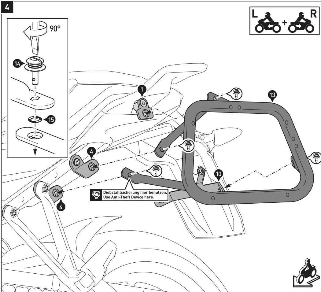
Verbinden Sie die Kofferträger (13) mit den Schnellverschlüssen (14) an den Befestigungslaschen (1) und (4) und dem Querverbinder (10). Sichern Sie die Schnellverschlüsse mit den Sicherungsscheiben (15).
