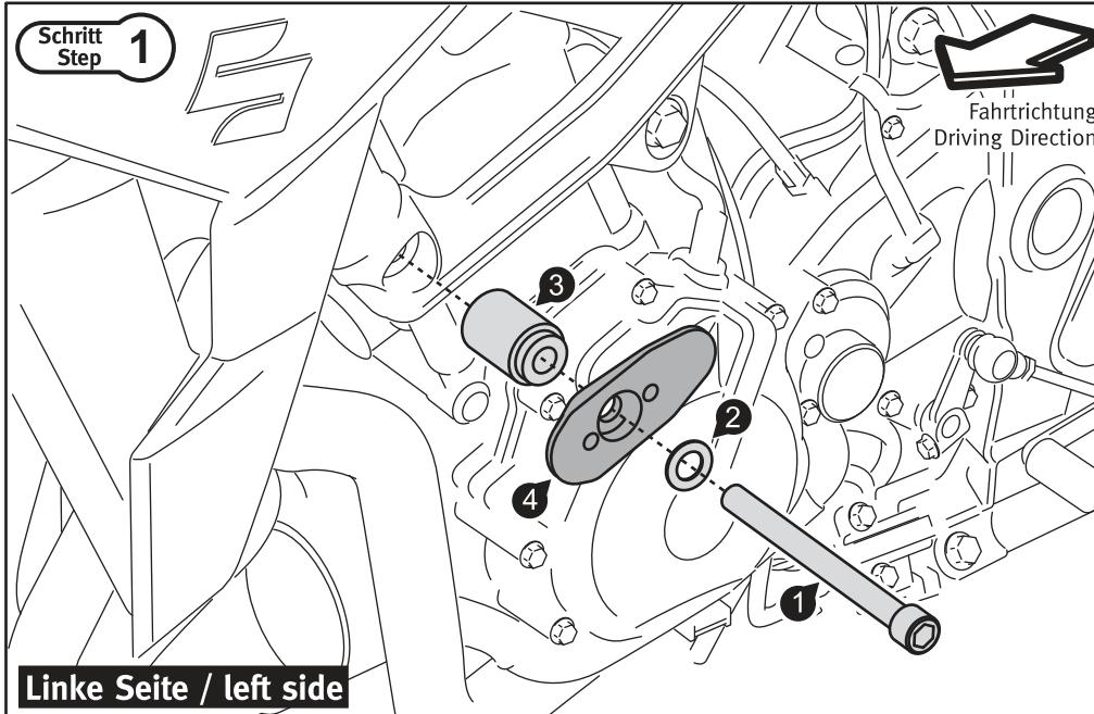
Lösen Sie die originale Motorhalteschraube am linken Montagepunkt (Fahrzeugseite links). Montieren Sie die Teile (1), (2), (3) und (4), wie in **Schritt 1** gezeigt. Richten Sie vor dem Anziehen der Schraube (1) die Basisplatte (4) entsprechend der Linienführung des Fahrzeugs aus. Ziehen Sie Schraube (1) an.
