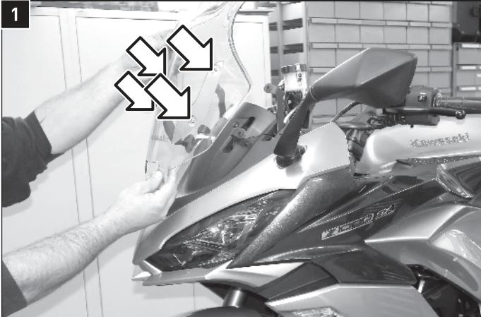
Lösen Sie die vier markierten Schrauben und entfernen Sie das Windschild.
