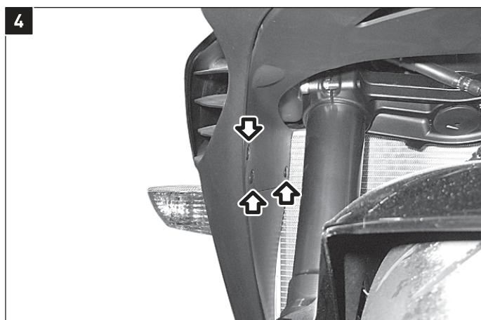
Lösen Sie beidseitig die gezeigten Kunststoffdübel der Seitenverkleidungen.
