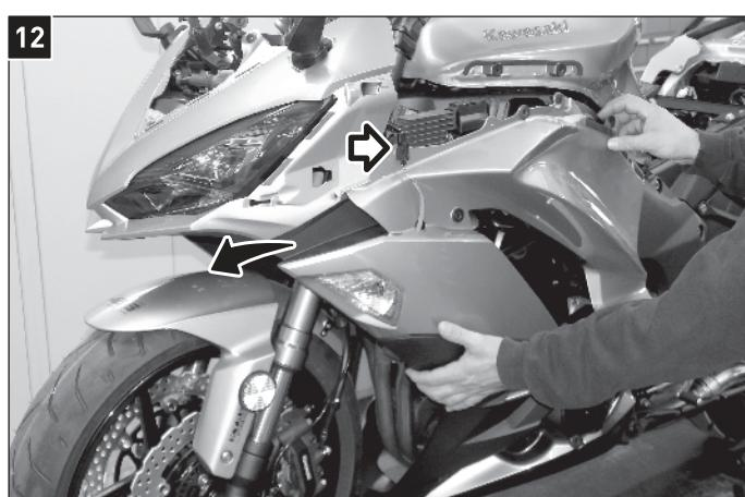
Entfernen Sie beidseitig die Blinkerkabel und nehmen Sie die Seitenverkleidungen ab.
