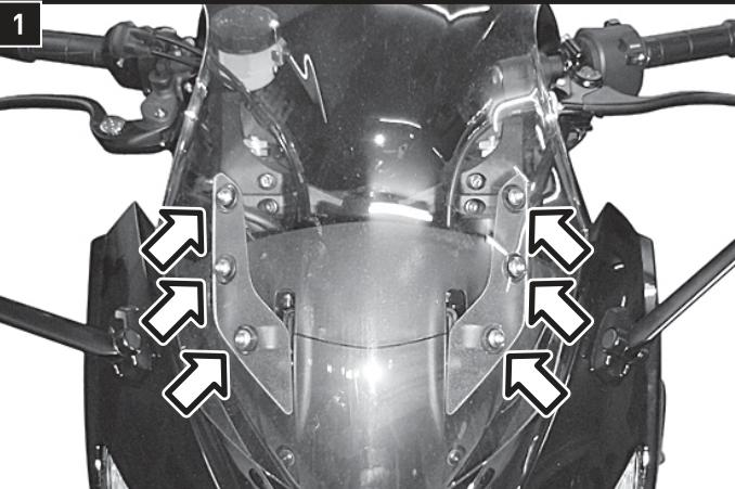
Lösen Sie die markierten Schrauben des Windschildes und entfernen Sie dieses vom Fahrzeug.
