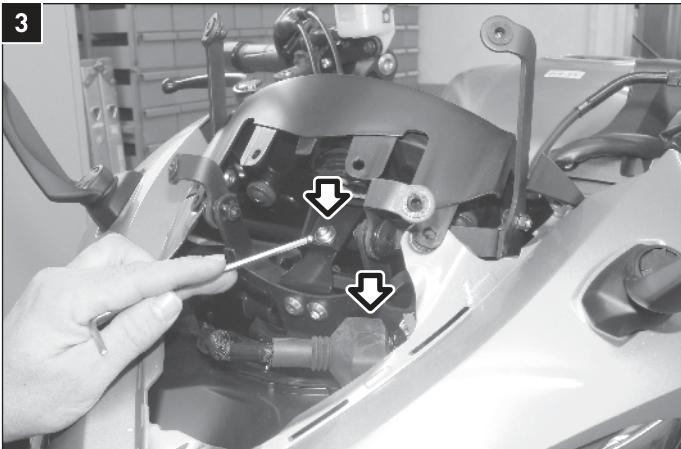
Lösen Sie die gezeigte Schraube und ziehen Sie den Stecker des Tachos.
