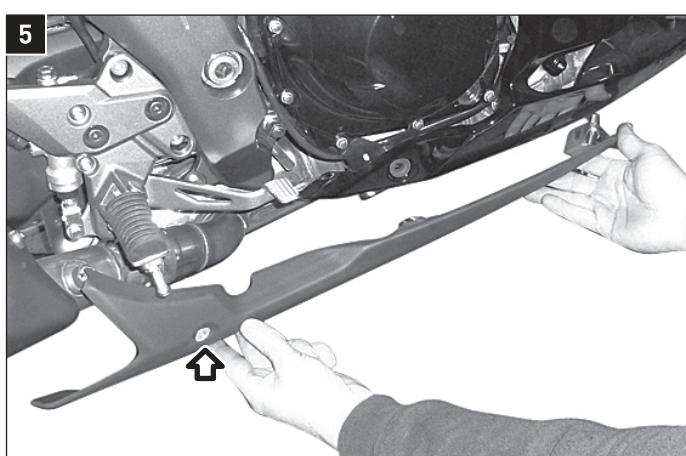
Lösen Sie die markierte Schraube der gezeigten Verkleidung und entfernen Sie diese.
