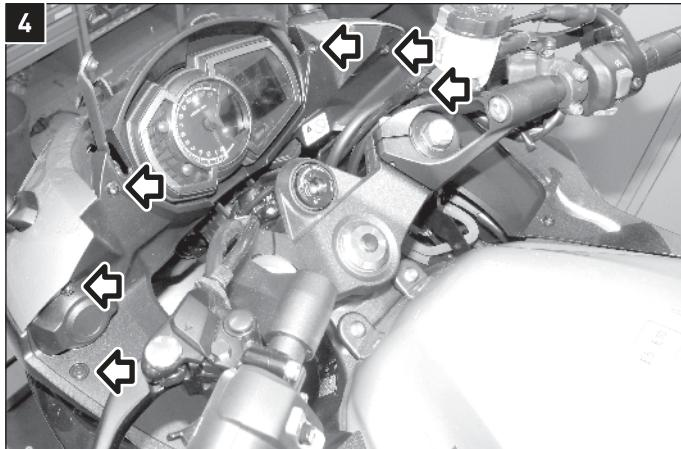
Lösen Sie die markierten Schrauben und Dübel der Cockpitverkleidung und entfernen Sie diese vorsichtig.
