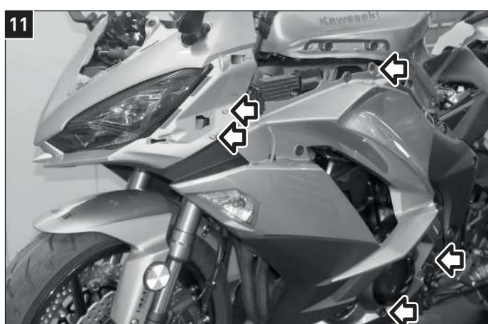
Entfernen Sie beidseitig die fünf Schrauben.
