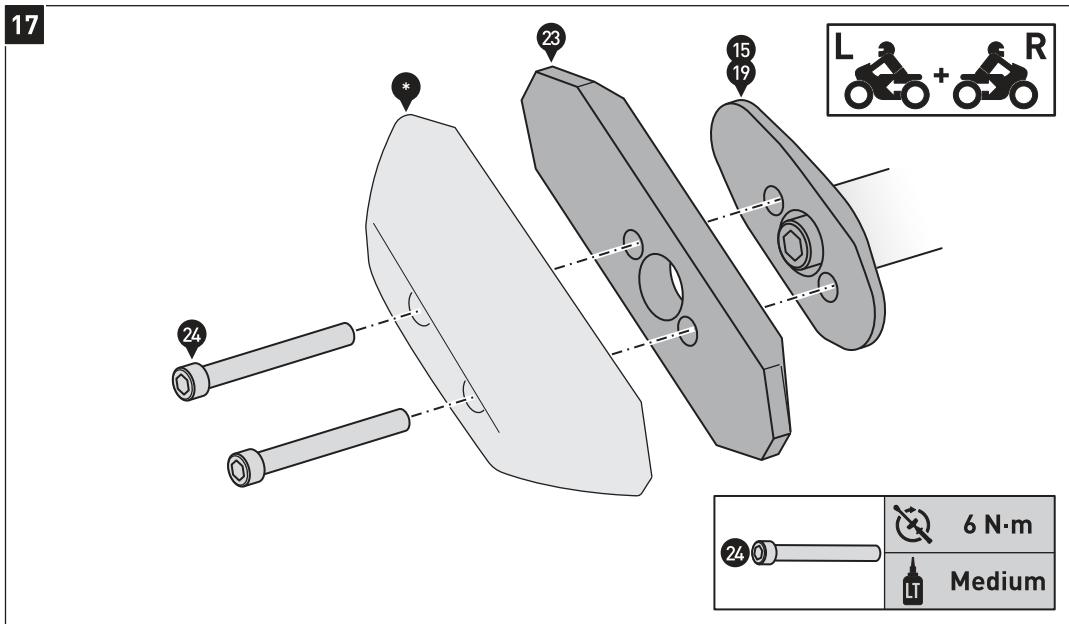
Verschrauben Sie die Sturzpads (25) auf beiden Seiten des Fahrzeugs an den Verschraubplatten (15) und (19).
