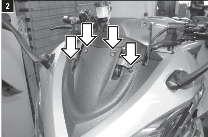
Lösen Sie die markierten Schrauben und Dübel der Frontabdeckung und entfernen Sie diese vorsichtig.
