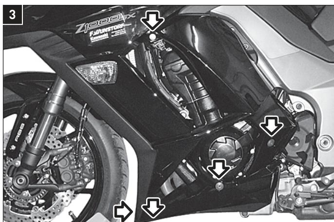
Lösen Sie die markierten Schrauben und Kunststoffdübel der linken Seitenverkleidung und entfernen Sie diese.
