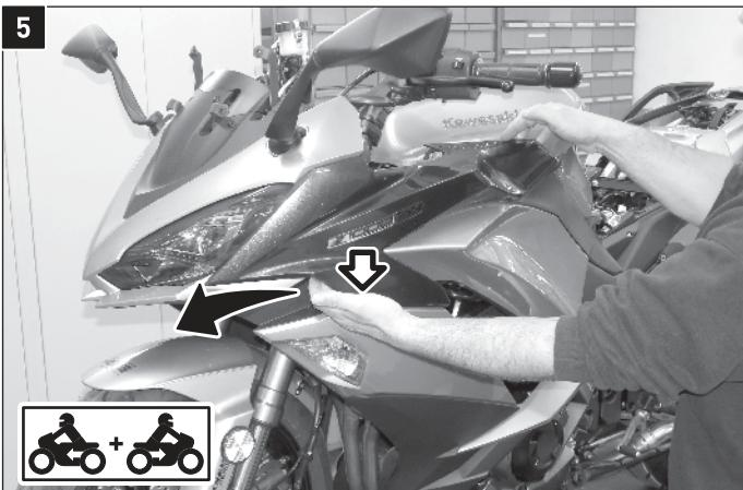
Lösen Sie je die Schraube und zwei Gummistecker der Seitenverkleidungen und ziehen Sie diese in Fahrtrichtung ab.
