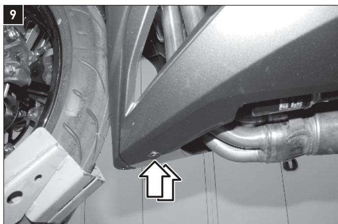
Entfernen Sie die beiden gezeigten Dübel.
