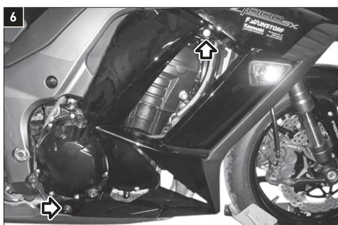
Lösen Sie die markierten Schrauben der rechten Seitenverkleidung und entfernen Sie diese.
