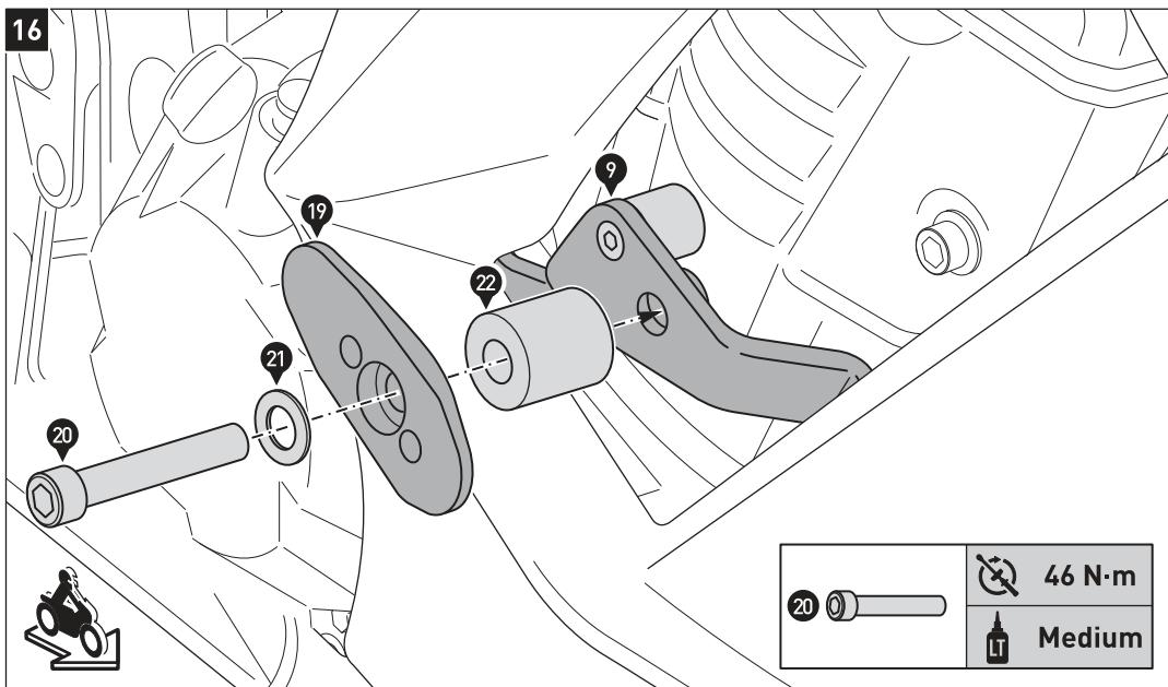
Verschrauben Sie die Verschraubplatte (19) am Anbaublech (9), wie in der Zeichnung gezeigt.
