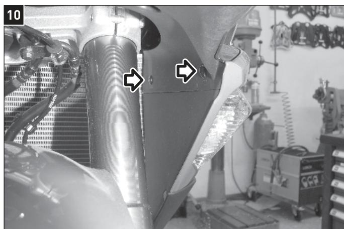
Entfernen Sie beidseitig zwei Dübel auf den Innenseiten der Verkleidung.
