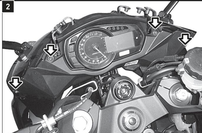
Lösen Sie die markierten Schrauben der Cockpitverkleidung und entfernen Sie diese vorsichtig.
