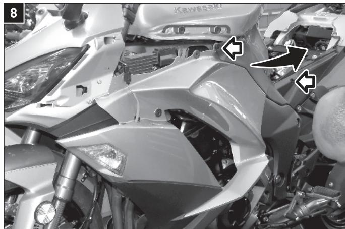
Entfernen Sie die beiden Schrauben und Gummistecker, um beidseitig die Verkleidungsteile abzunehmen.
