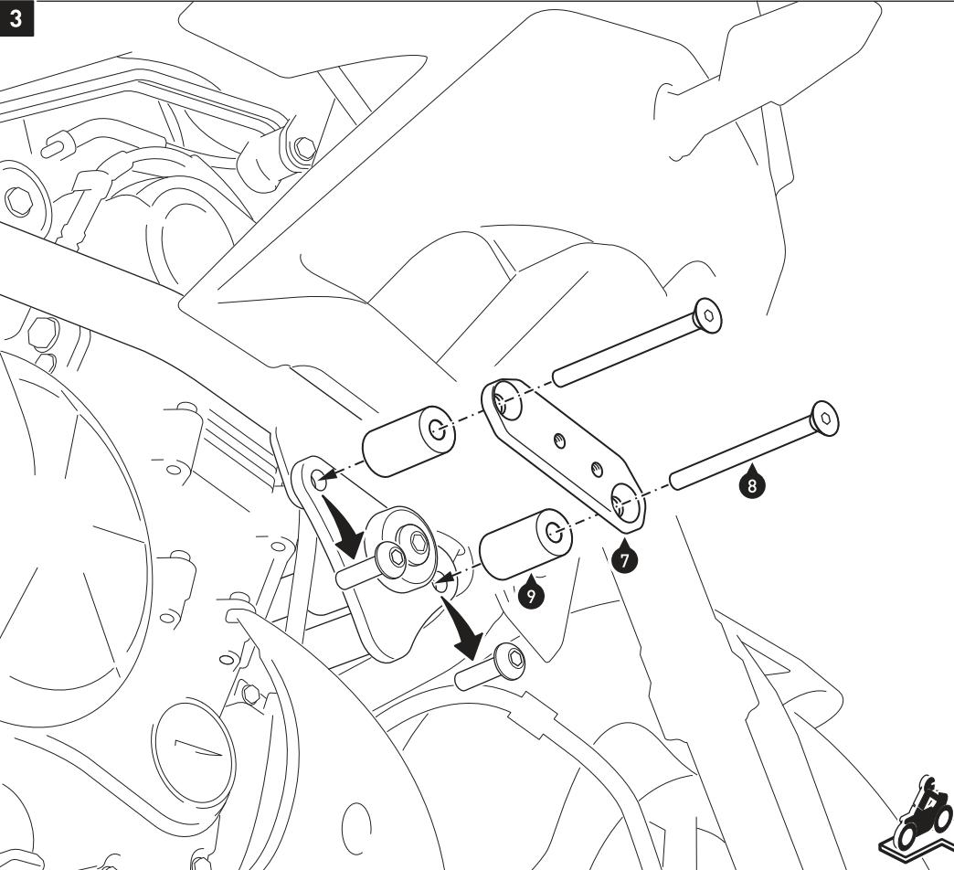
Entfernen Sie die gezeigten originalen Schrauben auf der rechten Fahrzeugseite.
