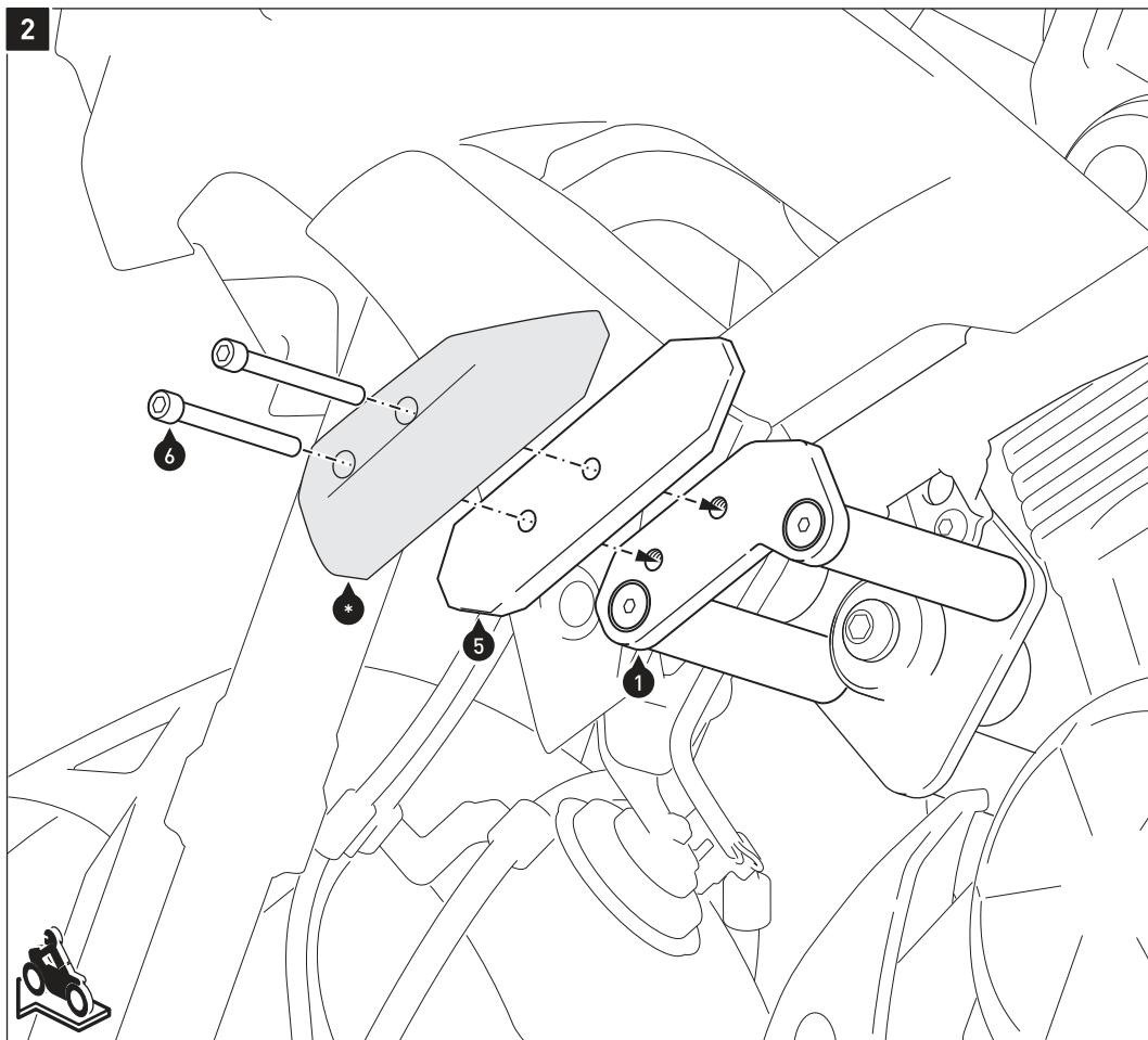
Verschrauben Sie die gezeigten Teile an dem Anbaublech (1).
