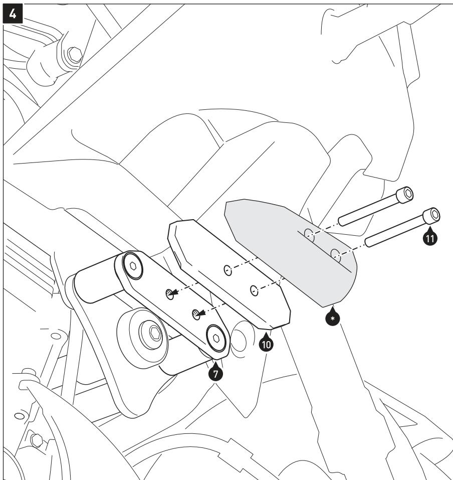
Verschrauben Sie die gezeigten Teile an dem Anbaublech (7).
