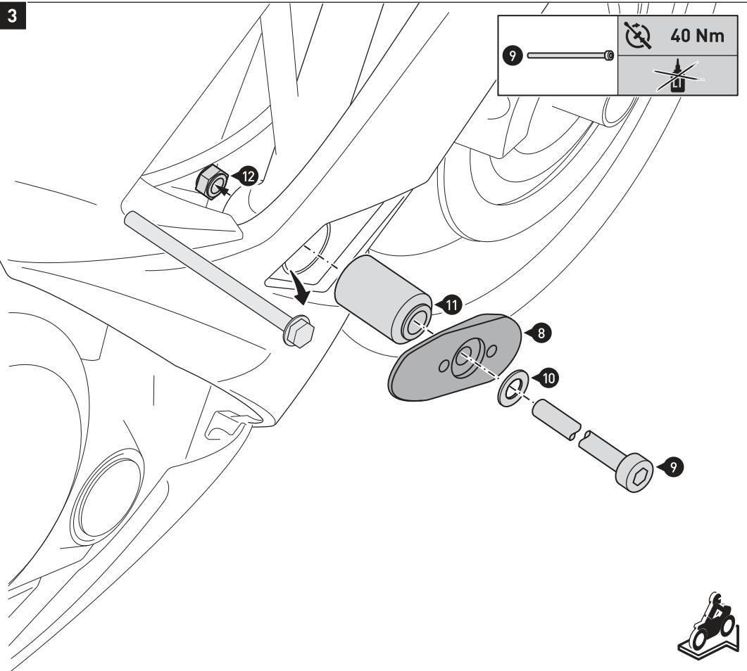
Entfernen Sie die original Motorhalteschraube und Mutter auf der linken Fahrzeugeite.
