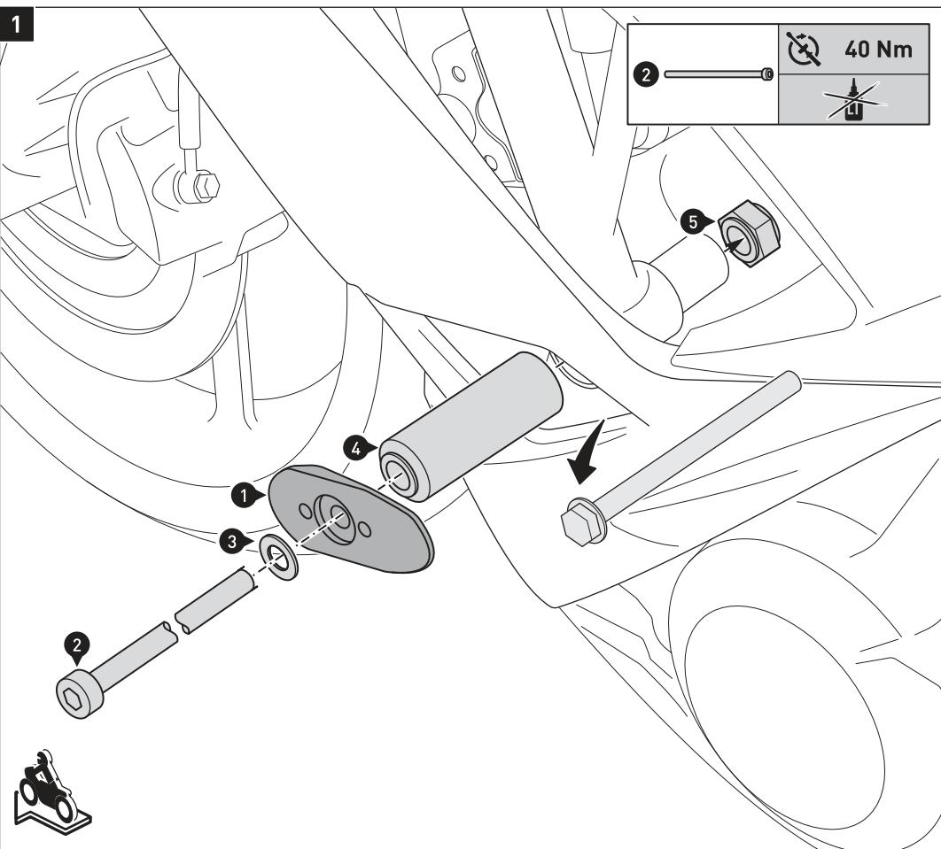
Entfernen Sie die original Motorhalteschraube und Mutter auf der linken Fahrzeugsseite.
