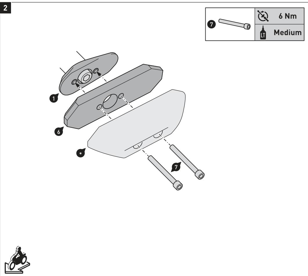
Verschrauben Sie die gezeigten Teile an der Verschraubplatte (1).
