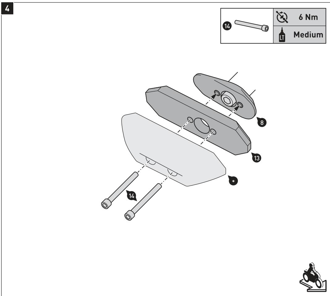
Verschrauben Sie die gezeigten Teile an der Verschraubplatte (8).
