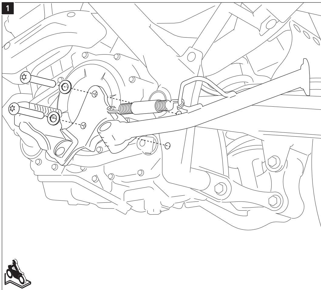
Lösen Sie die original Schrauben des linken Fußrastenhalters und entfernen Sie diesen vom Fahrzeug.
