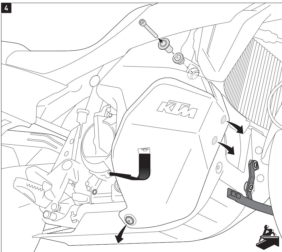
Entfernen Sie die gezeigten original Teile auf der **rechten** Fahrzeugsseite.
