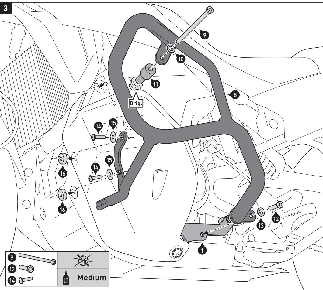
Verschrauben Sie den Sturzbügel (8) am Fahrzeug und dem Anbaublech (1), wie in der Zeichnung gezeigt. Verwenden Sie den original Gummidämpfer [Orig.] an dem oberen Anbaupunkt.
