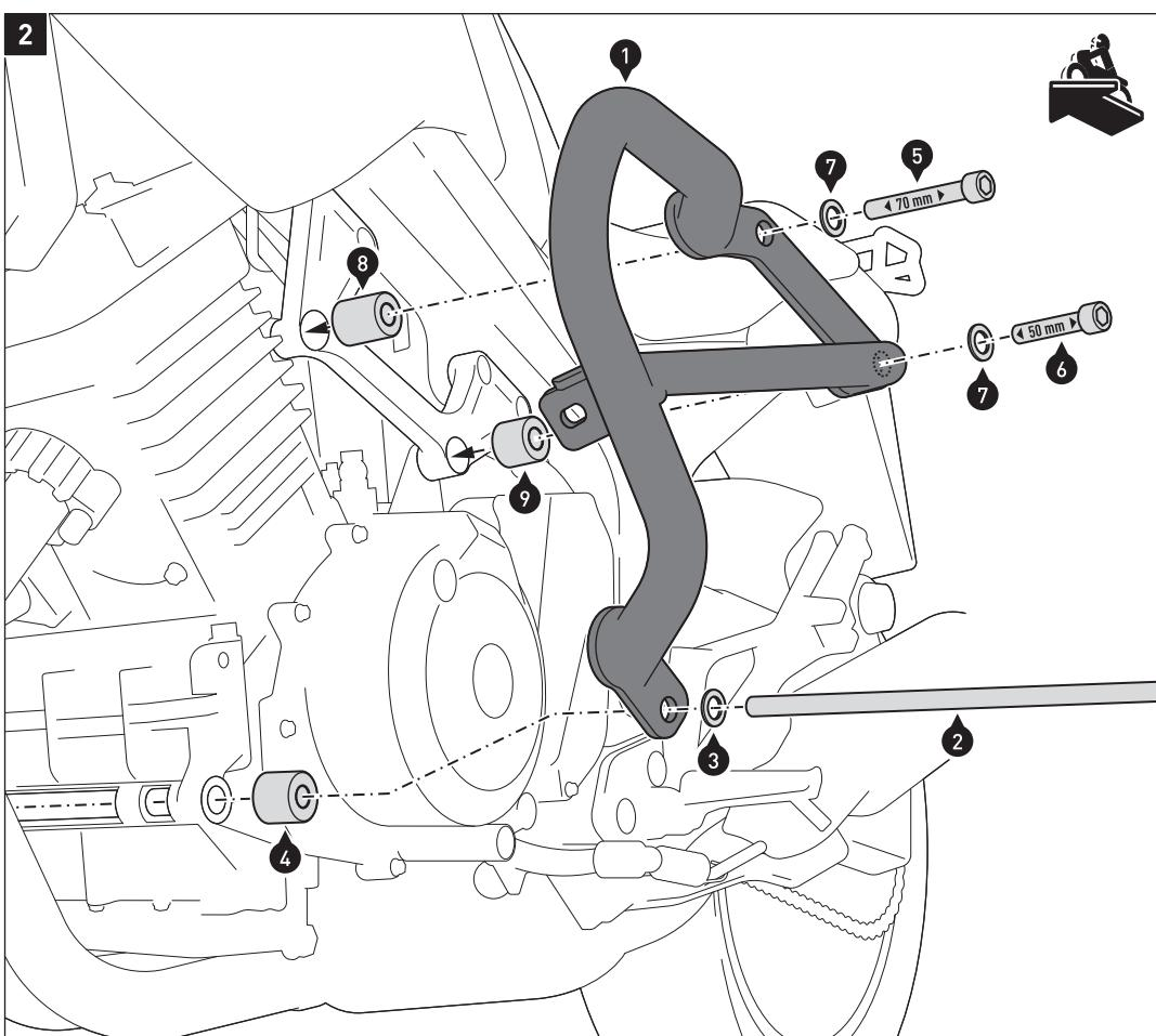
Verschrauben Sie den Sturzbügel (1) am Fahrzeug, wie in der Zeichnung gezeigt.
