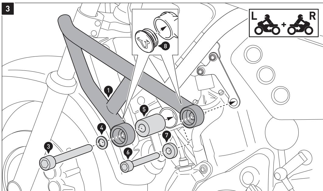
Verschrauben Sie anschließend den Sturzbügel (1) am Fahrzeug, wie in der Zeichnung gezeigt.
