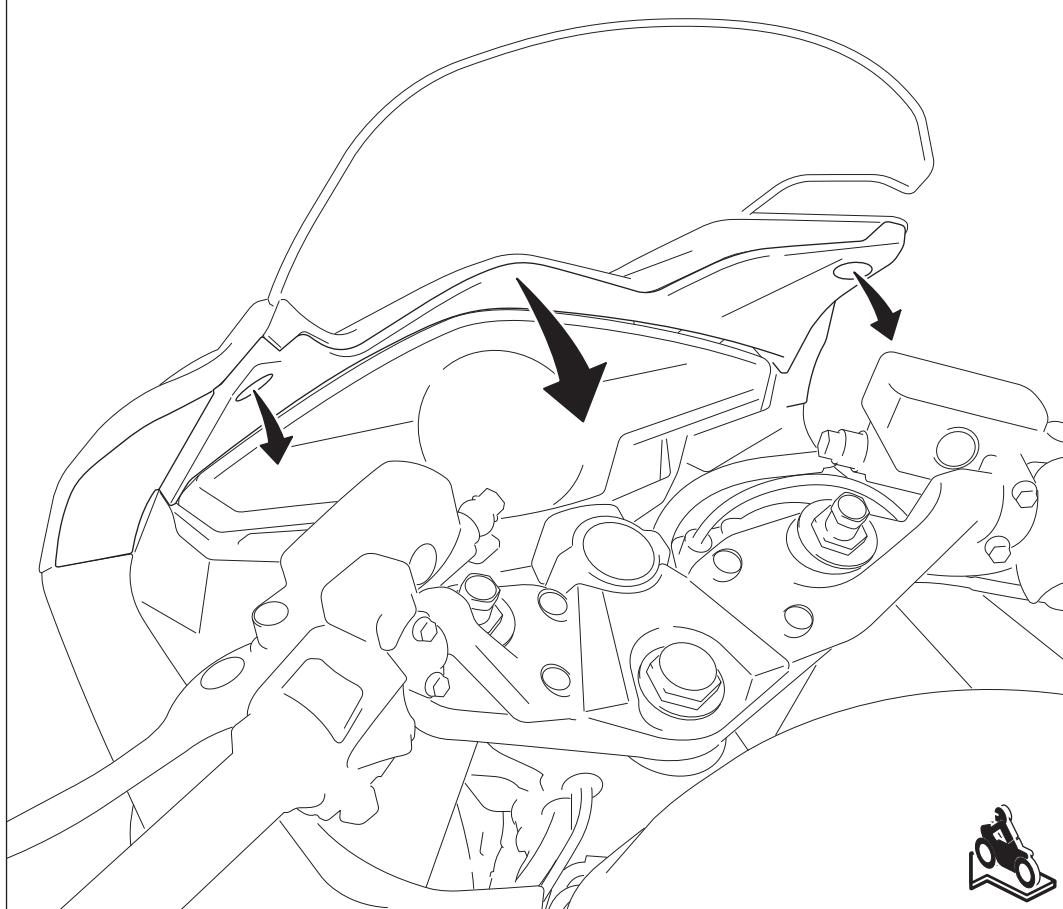
Lösen Sie die gezeigten originalen Schrauben und entfernen Sie vorsichtig die Cockpitverkleidung vom Fahrzeug.
